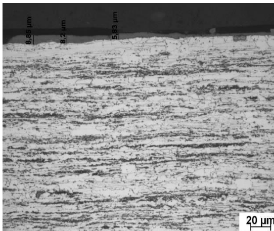
(c) Superfície inferior, após ataque com nital, com indicações de espessura.
