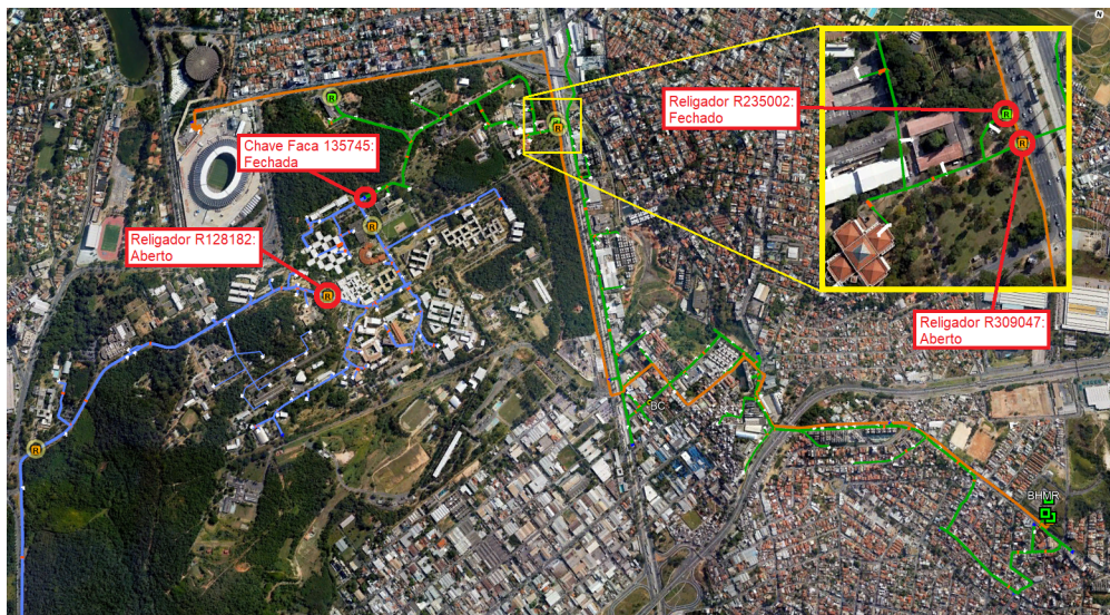
Figura 38 – Manobras realizadas. Fonte: CEMIG.
