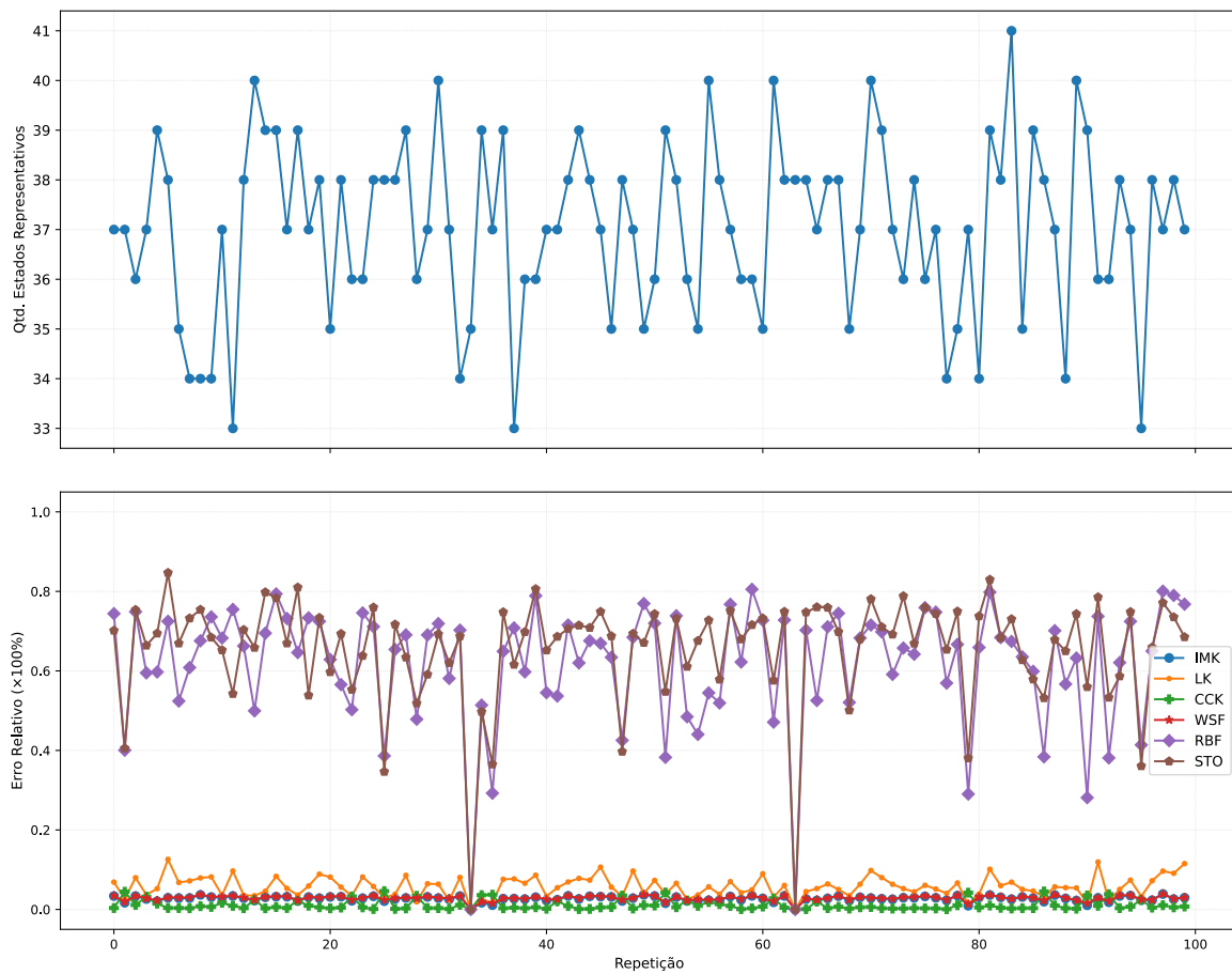
Figura 4.17 – Qualidade da estimativa em função da aleatoriedade do método de composição da matriz memória em 100 execuções.
