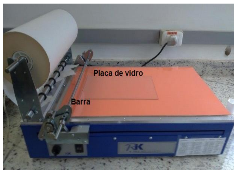
Figura 3. 10 – Imagem do equipamento wire-bar coating que foi utilizado na produção dos filmes.
