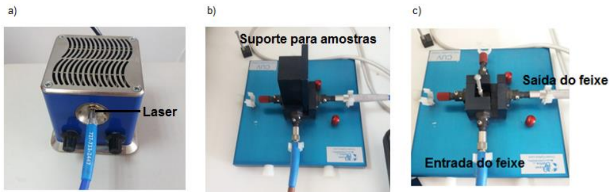
Figura 4. 10 - Espectrofotômetro Ocean Optics. a) Laser utilizado como fonte de excitação com comprimento de onda de 405 nm, b) Suporte para o posicionamento das amostras e c) Posição de entrada e saída do feixe.
