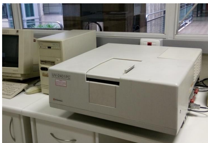
Figura 4. 13 - Equipamento UV-240 PC utilizado para obter os espectros de absorção na faixa de 190 a 900 nm.
