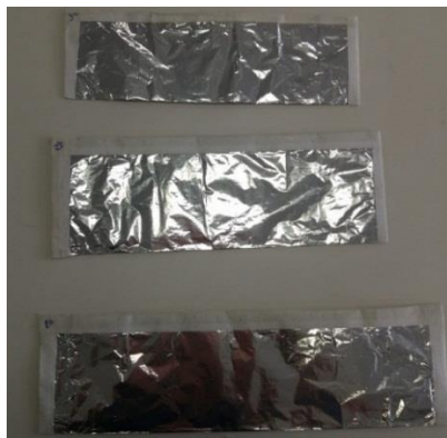
Figura 4. 3 - Preparo dos filmes para o processo de irradiação.
