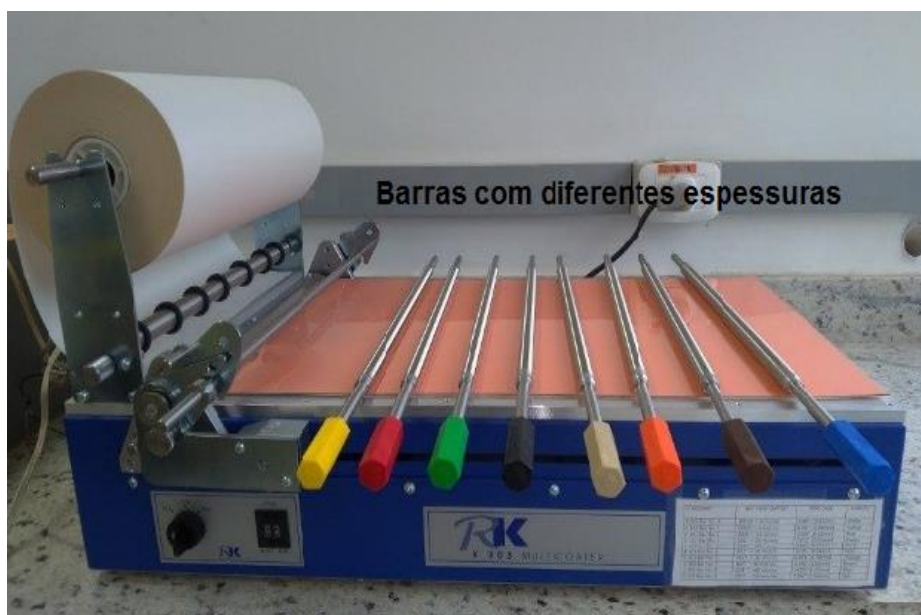
Figura 3. 11 - Imagem das barras com diferentes espessuras sobre o equipamento wire-bar coating
