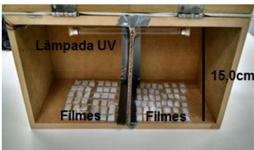
Figura 4. 4 - Arranjo experimental construído para realizar a irradiação ultravioleta nos filmes que foram produzidos.
