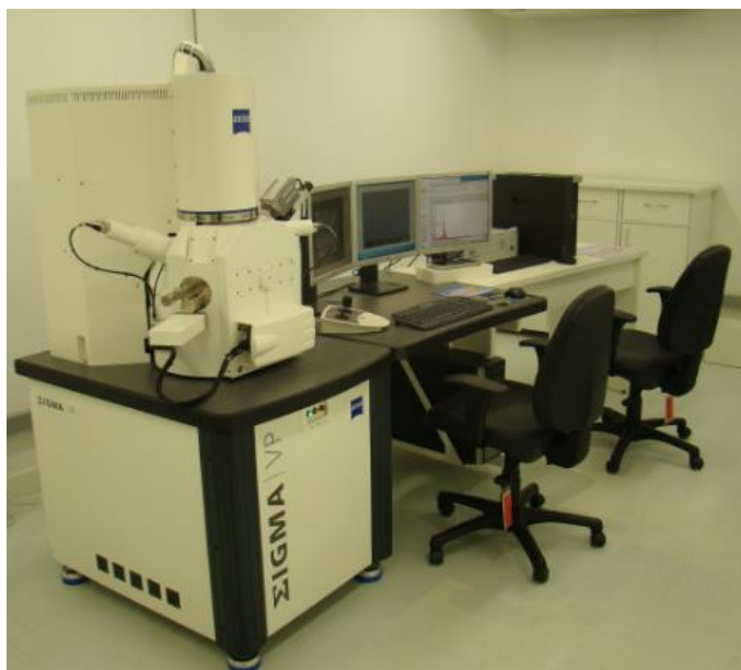
Figura 4. 14 - Equipamento Microscópio Eletrônico de Varredura com emissão por efeito de campo.
