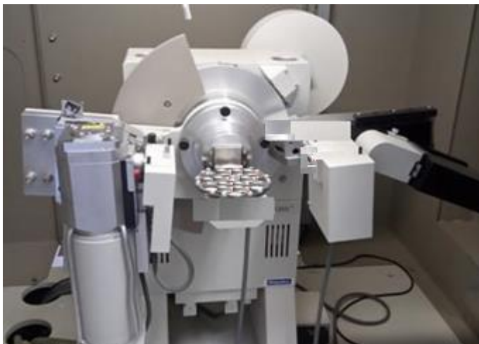
Figura 4. 15 -Equipamento Difratorômetro de raios X do Laboratório de Difração de Raios X – CDTN [90]
