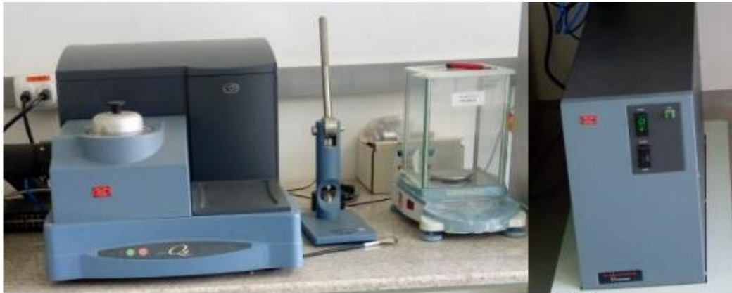
Figura 4. 16 -Equipamento de DSC Q10 TA Instrumentes utilizado para realizar as análises térmicas das amostras.
