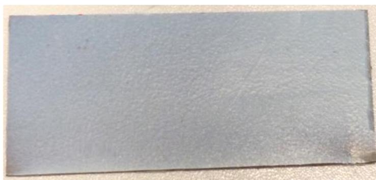
**Figura 4.2** - Chapa revestida com pós de PET-PC, prensado a quente.
