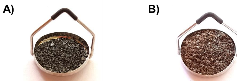
Figura 64 - Amostra de Grafite A) antes e B) após o ensaio de termogravimetria
