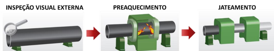
Figura 19 - Esquema do processo de jateamento dos tubos de aço
