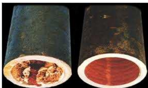
Figura 2 - tubo sem revestimento interno e com incrustações (esquerda) e com revestimento interno sem incrustações (direita)
