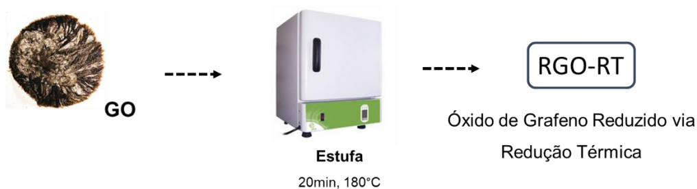
Figura 31 - Procedimento de síntese do RGO-ET a partir redução térmica do GO
