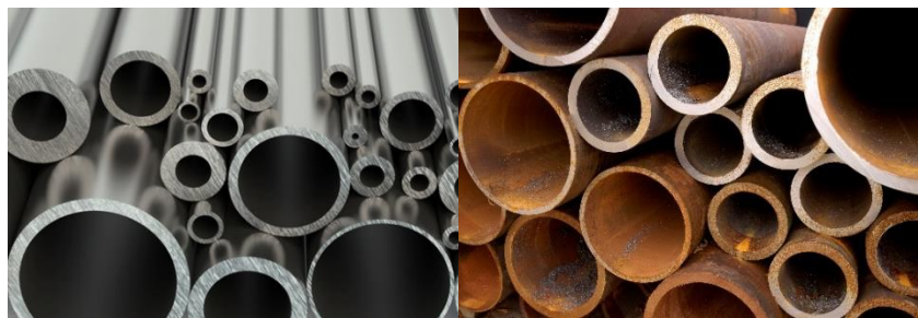
Figura 1 - Tubo de aço sem corrosão (esquerda) e com corrosão (direita)
