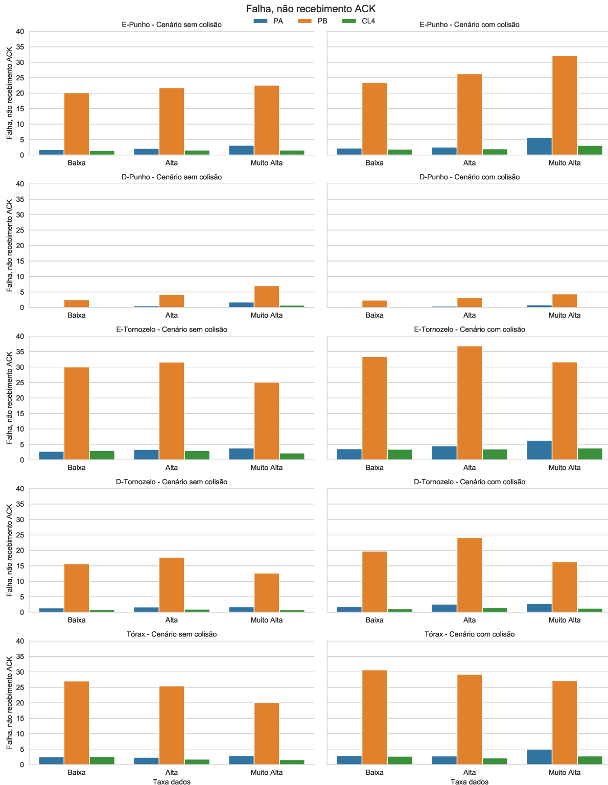
Figura 6.23: Falhas devido ao não recebimento do ACK para as Taxas Muito Alta, Alta e Baixa.
