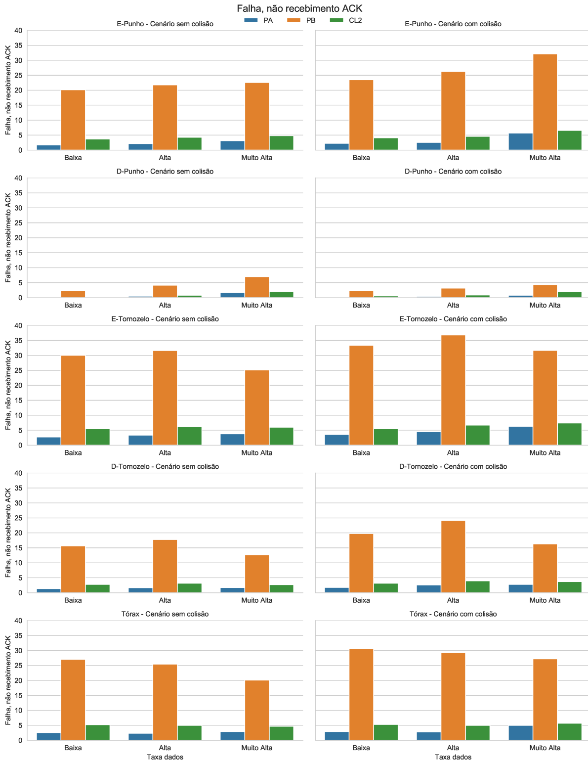
Figura 6.8: Falhas devido ao não recebimento do ACK para as Taxas Muito Alta, Alta e Baixa.
