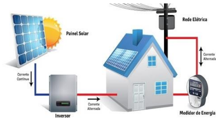
Figura 3 - Estrutura básica de um SFCR
