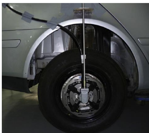
Figura 24 – Transdutor de força instalado na roda traseira do veículo
