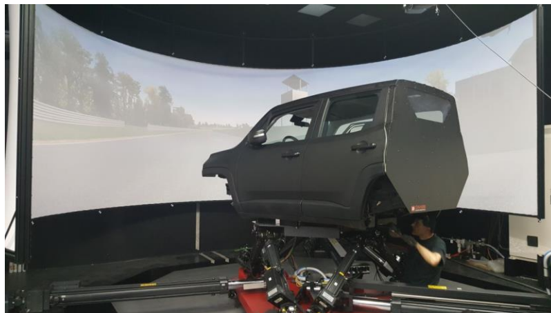
Figura 20 – Simulador de dinâmica veicular da parceria entre FIAT Chrysler Automóveis e Pontifícia Universidade Católica de Minas Gerais
