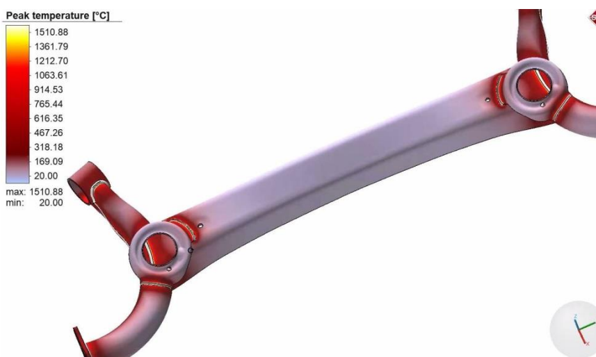
Figura 43 – Simulação do processo de soldagem (Simufact Welding) – Temperaturas máximas
