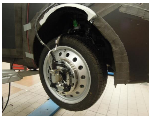
Figura 47 – Roda dinamométrica utilizada na coleta do sinal de durabilidade
