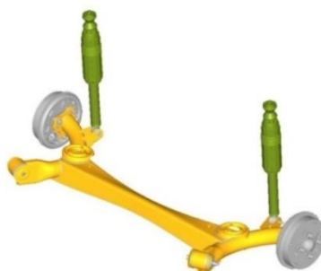
Figura 1 – Exemplo de suspensão traseira eixo de torção utilizada em veículos de pequeno e médio porte
