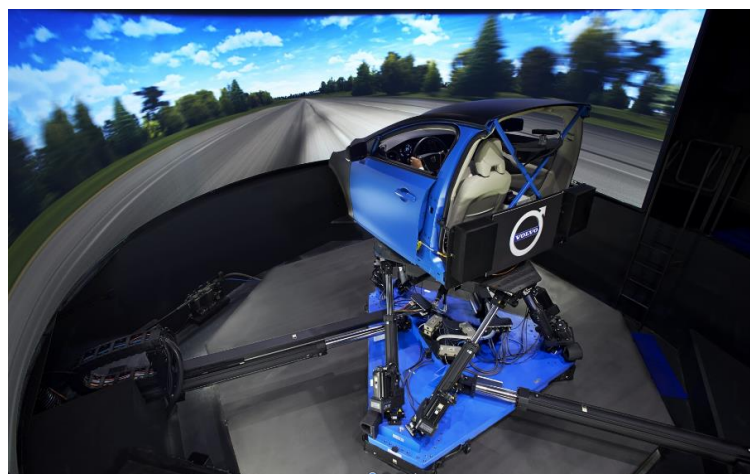
Figura 19 – Simulador de dinâmica veicular instalado na Volvo Car Group
