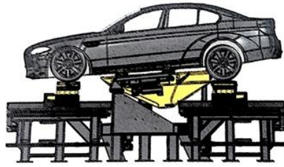
Figura 11 – Simulação de manobras no banco elastocinemático
