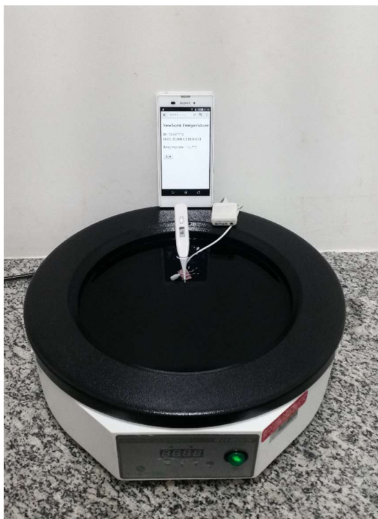
Fig. 4 Termômetro padrão e protótipo submerso em um equipamento de banho-maria histológico para avaliar a eficácia e confiabilidade da temperatura pelas duas técnicas de aferição.
