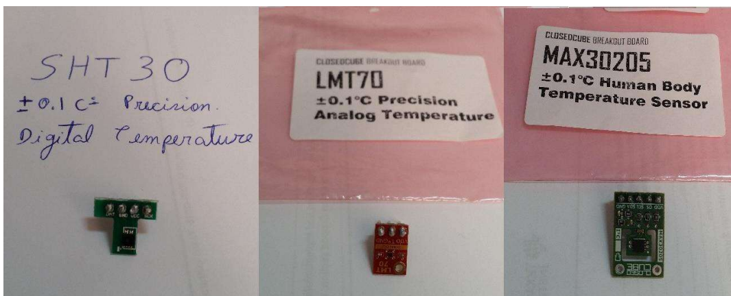
Figura 3 - Imagem dos sensores considerados na seleção de componente para fabricação do protótipo
