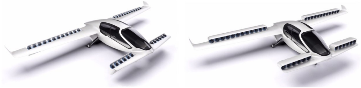
Figura 9 – Aeronave Lilium Jet. Detalhe dos motores elétricos dutados (a) Configuração VTOL. (b) Configuração de cruzeiro.
