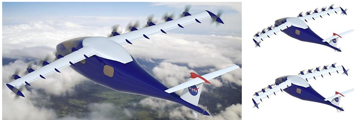
Figura 4 – Aeronave conceito LEAPTech. Detalhe na variação do ângulo de incidência da asa.
