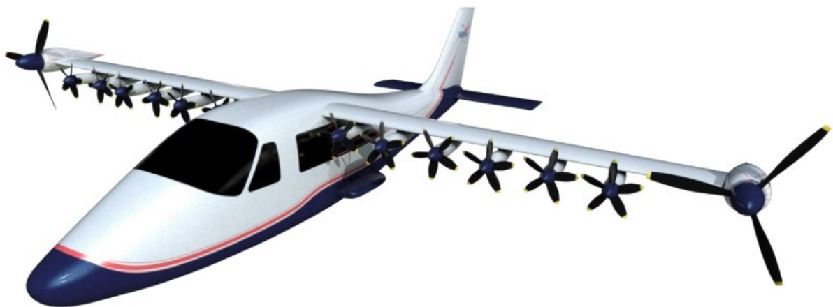
Figura 7 – NASA X-57 "Maxwell". Aeronave demonstradora da tecnologia DEP.
