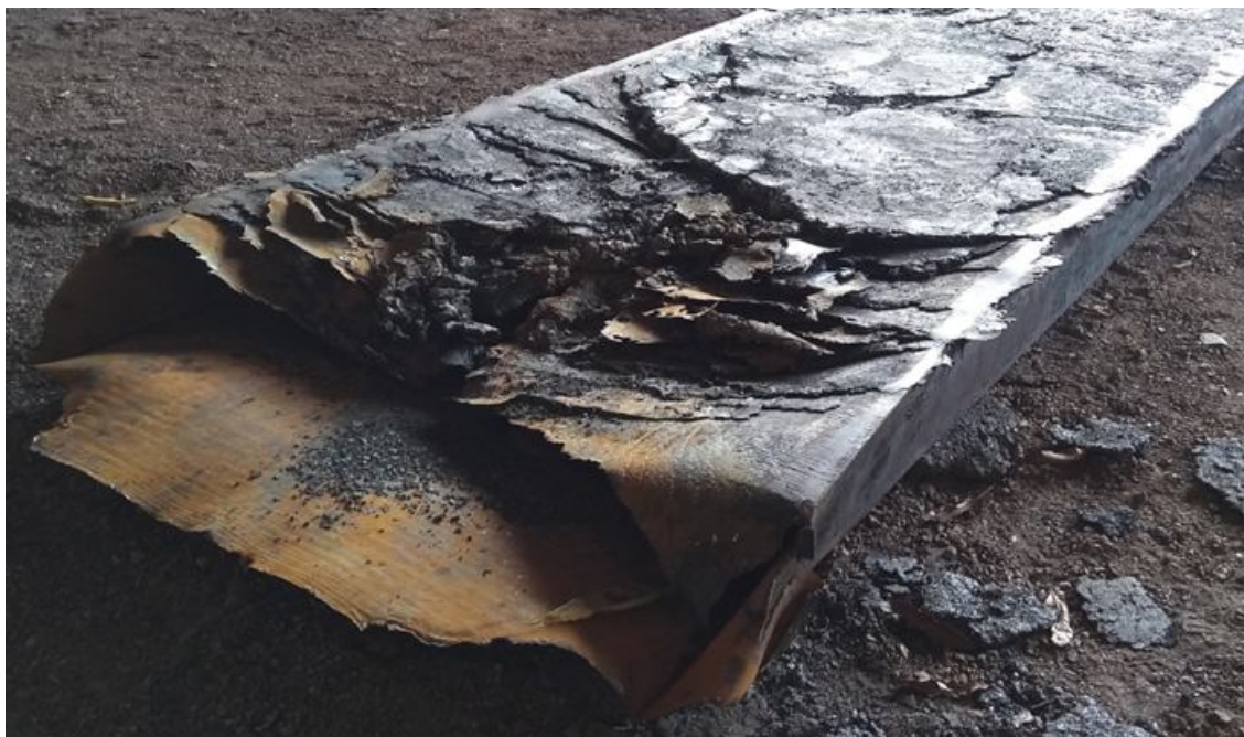
Figura 5.27: Aspecto físico da face da placa que gerou as taxas térmicas no canal 18 no SDRP.
