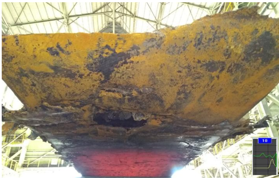
Figura 5.20: Aspecto físico da face da placa que trabalhou com os canais de 05 ao 11 do SDRP.
