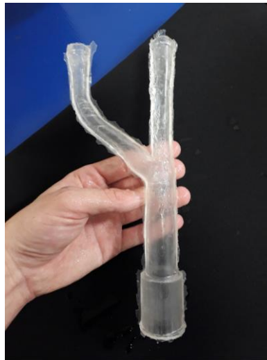
FIGURA 64 Corpo de prova em silicone ótico (Sylgard 184) após o ajuste com silicone adesivo (Factor II)
