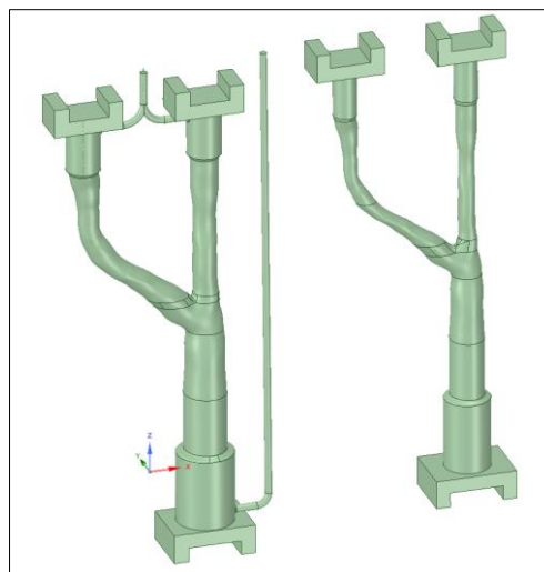
FIGURA 36 Modelo geométrico de núcleos interno e externo para a fundição
