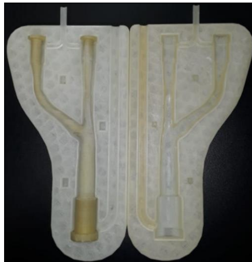
FIGURA 39 Molde externo, com o canal de injeção ampliado, impresso.
