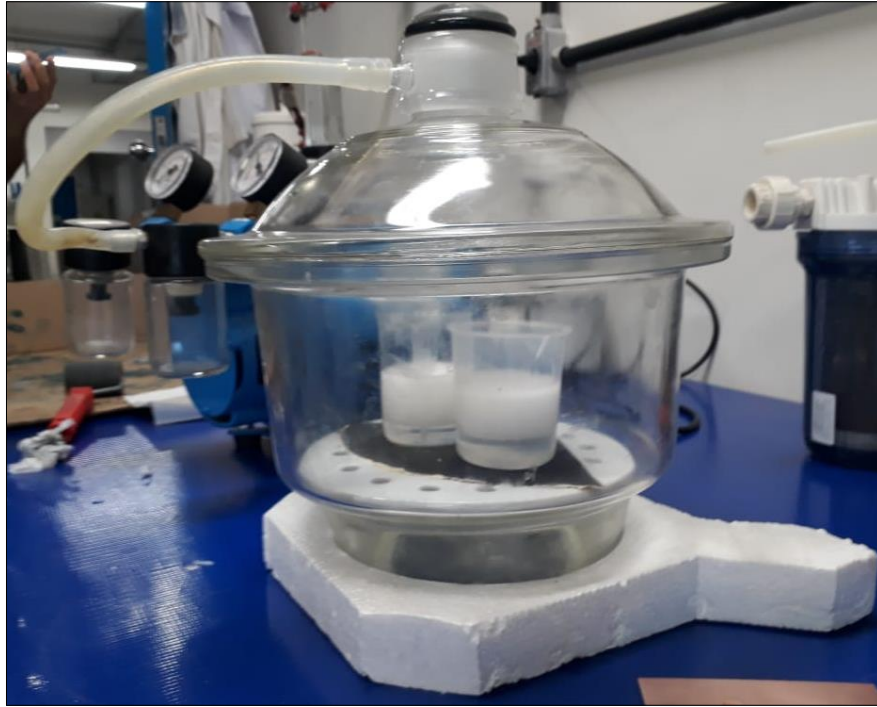
FIGURA 42 Câmara de vácuo utilizada para a retirada de bolhas do silicone
