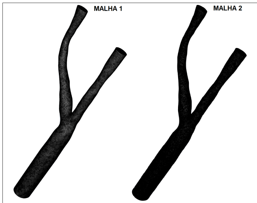
FIGURA 59 Malhas avaliadas no teste de malha das simulações das condições fisiológicas sem cateter
