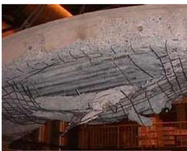
**Figura 9** – Spalling em elemento de concreto exposto ao fogo
