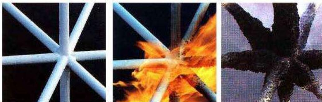
**Figura 13** – Tinta intumescente exposta ao fogo
