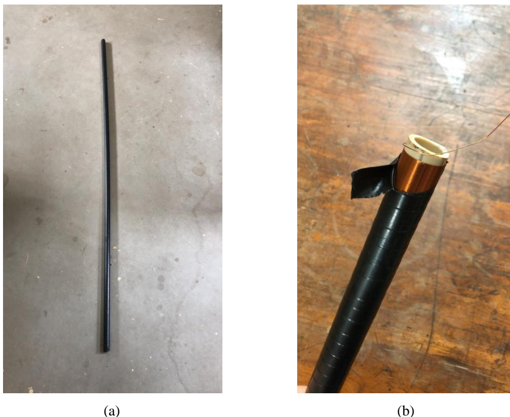
Figura 4.2 – (a) Unidade ATL construída com tubos PVC ½” e 3m de comprimento, (b) utilizando fio esmaltado de cobre AWG #28, resultando em aproximadamente 2600 espiras/m
