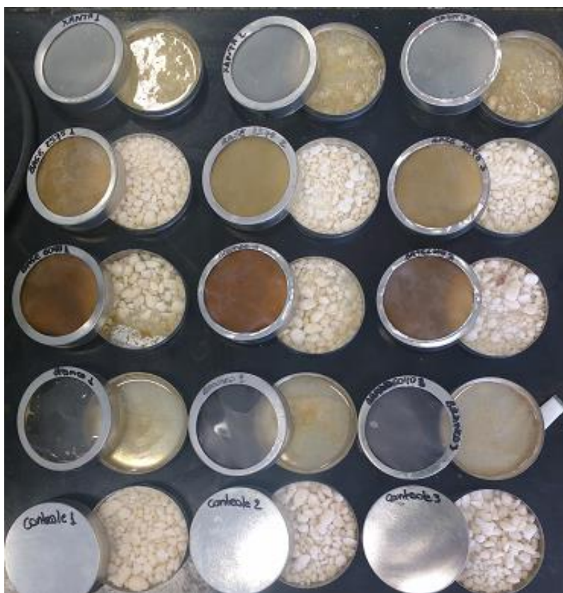
FIGURA 65: Foto dos recipientes após a realização do teste de WVP
