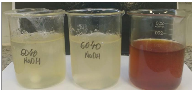
FIGURA 23: Mudança de coloração durante o preparo da amostra Base6040. Da esquerda para a direita: Amostra solubilizada à temperatura ambiente e depois homogeneizada a 45°C e a 97°C
