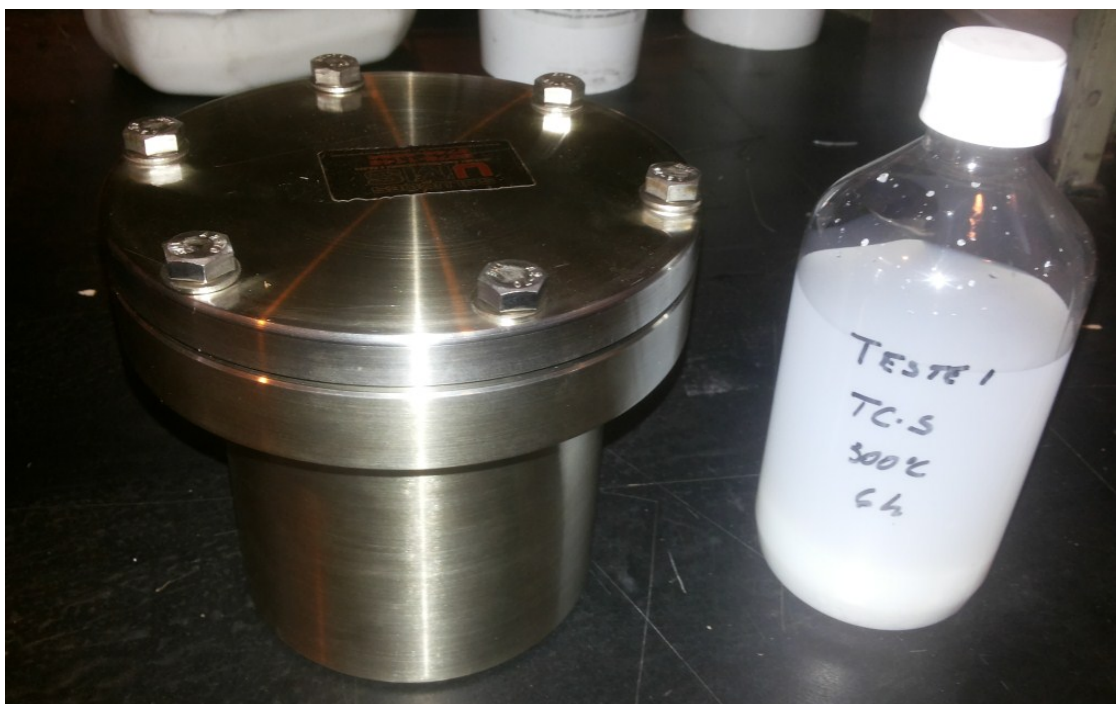
Figura 4.2 - Vaso de pressão utilizado no tratamento hidrotérmico.
