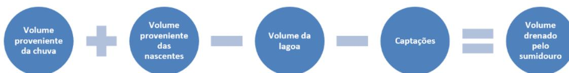
**Figura 22: Fluxograma para se obter o volume anual, aproximado, drenado pelo sumidouro nos períodos analisados.**
