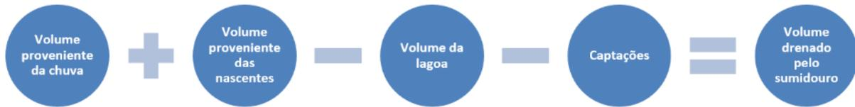
Figura 7: Representação do raciocínio utilizado para se obter o volume anual, aproximado, drenado pelo sumidouro nos períodos analisados.
