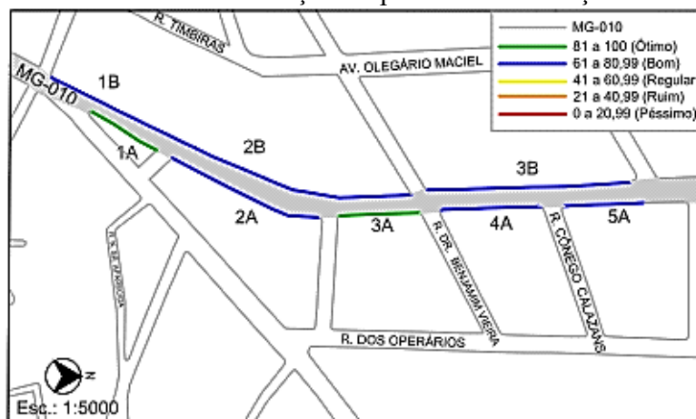
Figura 39: Indicador conservação do pavimento da calçada – Trecho 1
