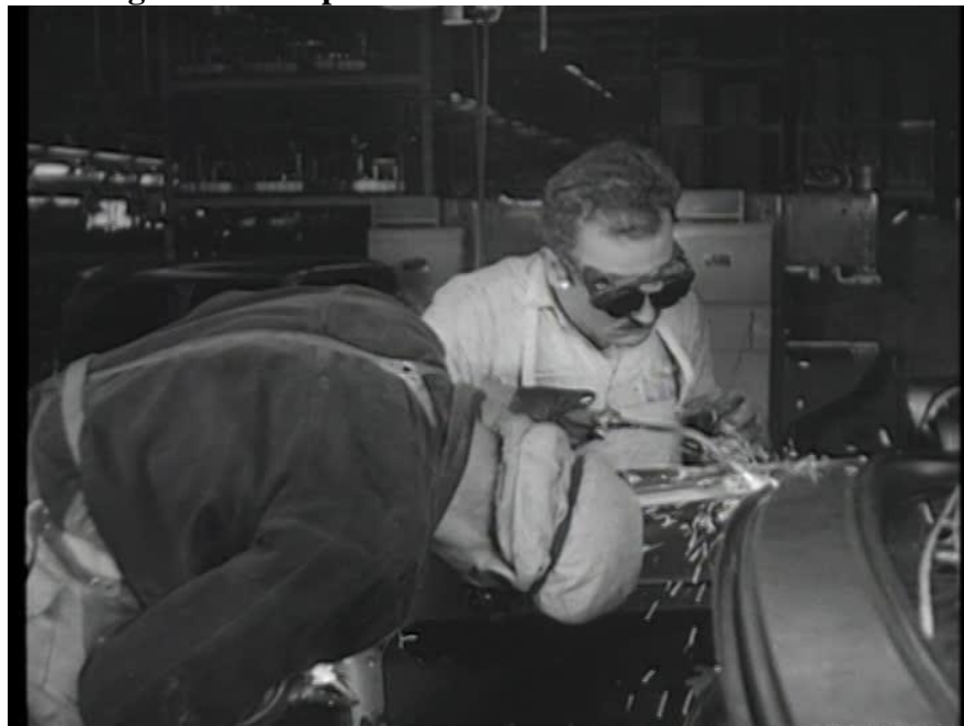
Figura 35 –Brasagem manual por chama na indústria automotiva na década de 60.
