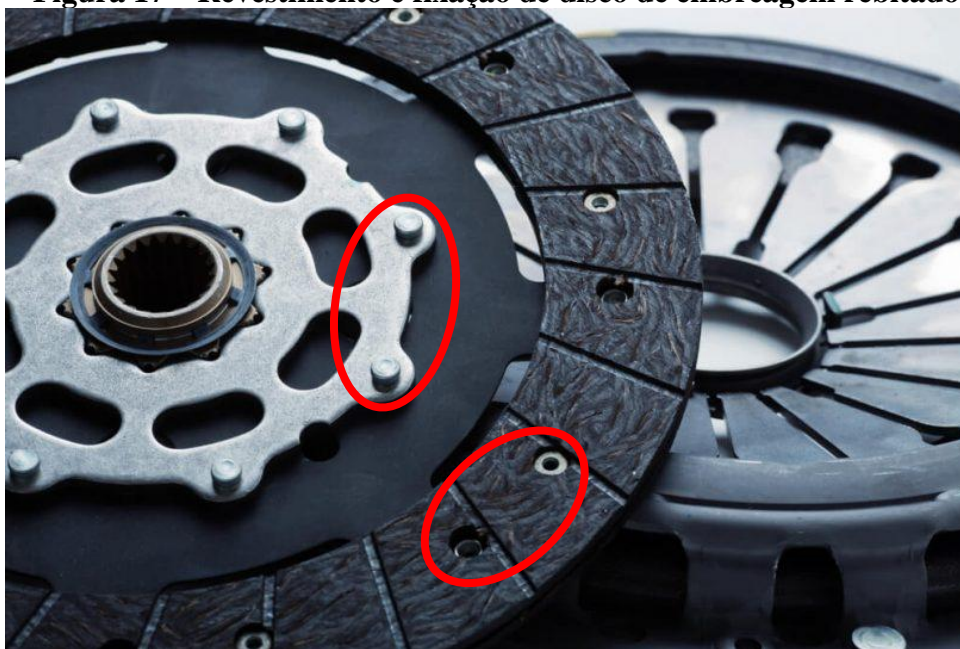
Figura 17 – Revestimento e fixação de disco de embreagem rebitados.
