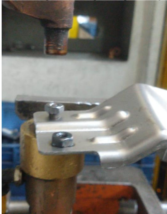
Figura 26 – Posicionamento preciso de componentes para soldagem por projeção.
