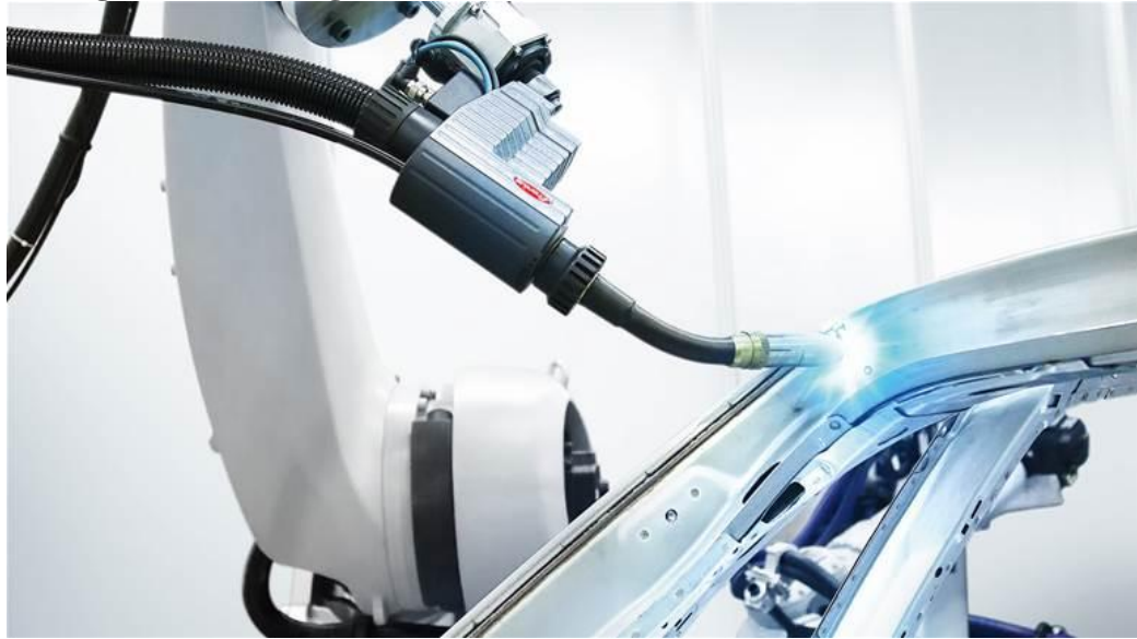
Figura 52 – Soldagem GMAW robotizada de carroceria automotiva.
