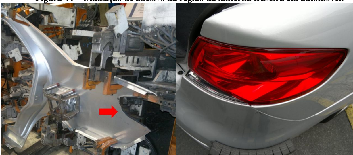
Figura 44 – Utilização de adesivo na região da lanterna traseira em automóvel.
