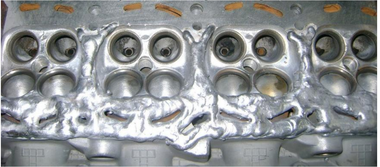
Figura 32 – Cabeçote em alumínio recuperado com o processo GTAW.
