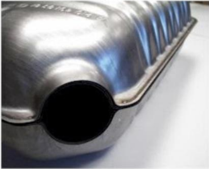
Figura 29 – Tanque de combustível soldado por costura.
