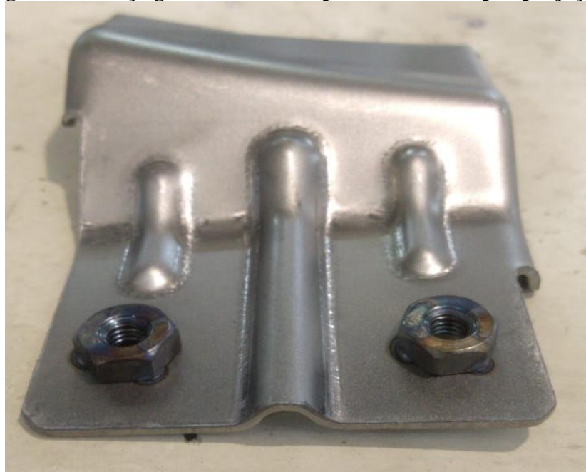
Figura 25 – Peça galvanizada com porcas soldadas por projeção.
