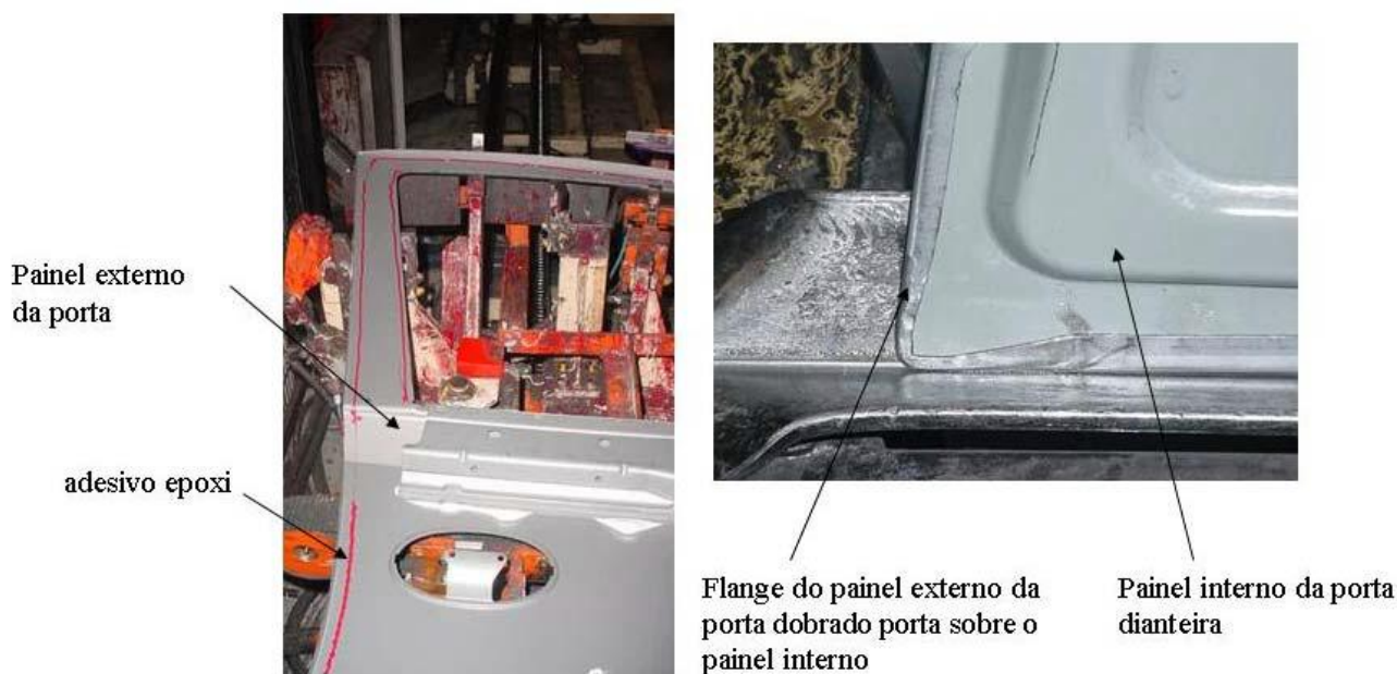
Figura 43 – Utilização de adesivos na indústria automotiva em substituição à soldagem.
