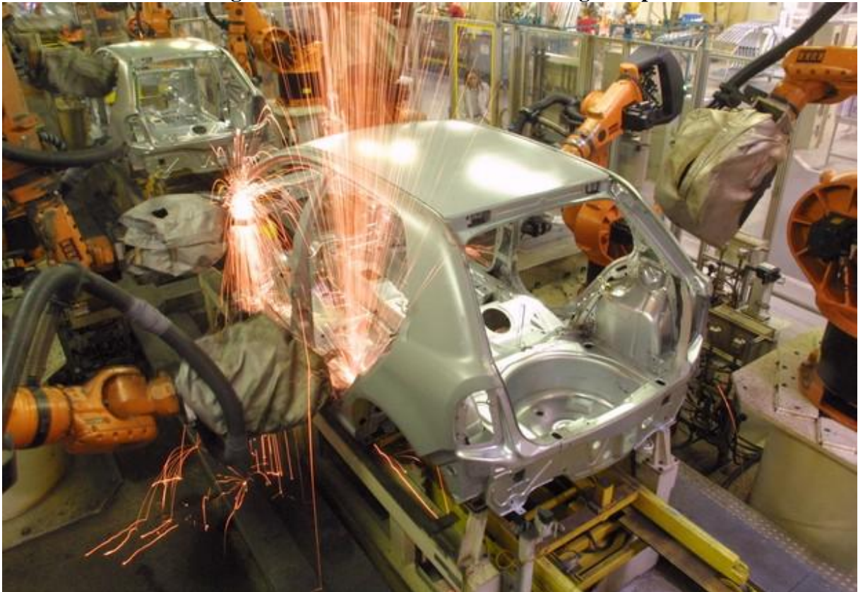
Figura 51 – Linha robotizada de soldagem a ponto.
