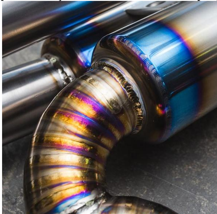
Figura 33 – Escapamento em aço inoxidável soldado e anodizado pelo processo GTAW;
