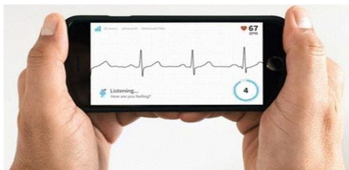
Figura 2 - Monitor cardíaco AliveCor™ conectado a um iPhone®
