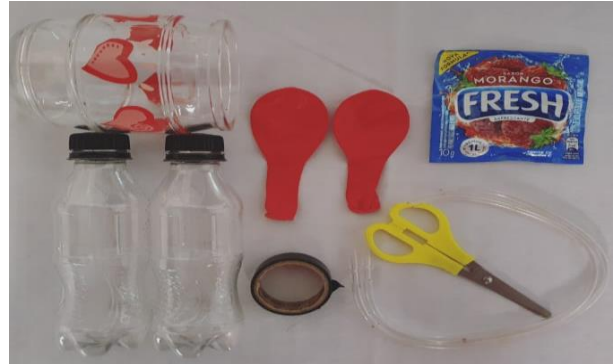
Figura 4 - Materiais necessários para o experimento simulando a sístole e a diástole cardíaca.
