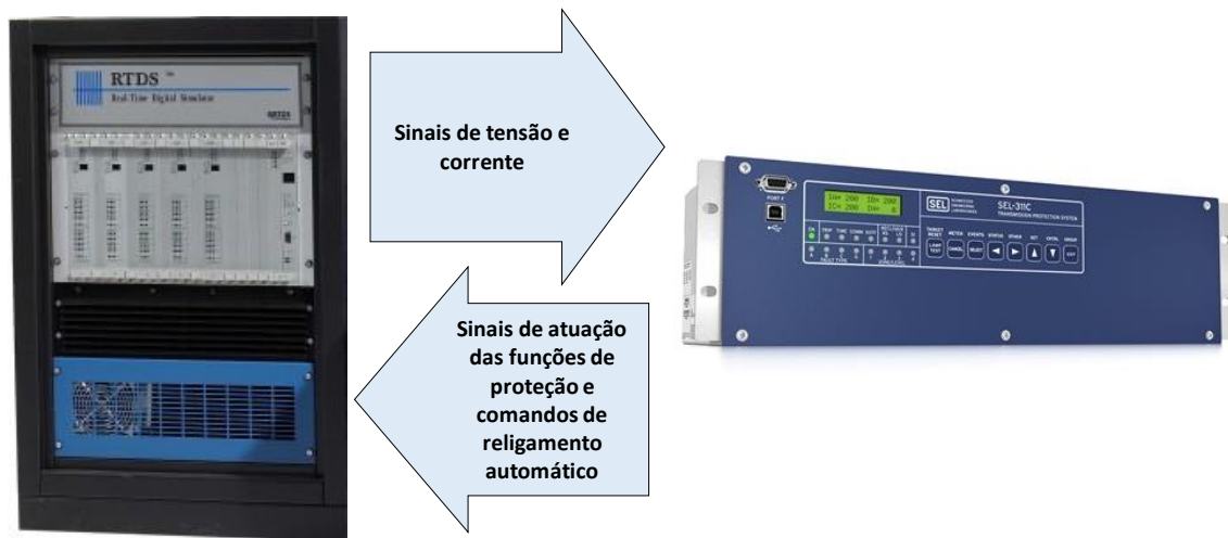
Figura 2.2 – Esquema de teste de malha aberta de um relé de distância Schweitzer SEL-311C com uma mala de testes Omicron CMC 256 Plus.
