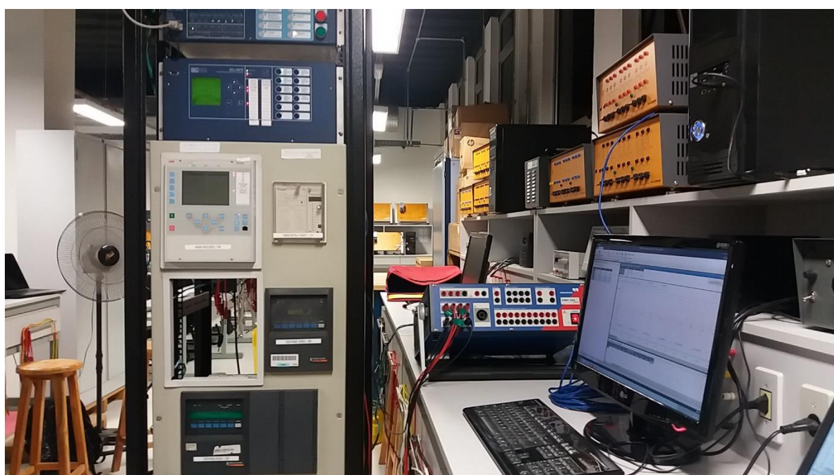
Figura 4.19 – Montagem feita com o simulador de sistema elétrico de potência OMICRON CMC 256 Plus e o relé SEL-487E para avaliar o desempenho da metodologia de testes proposta.
