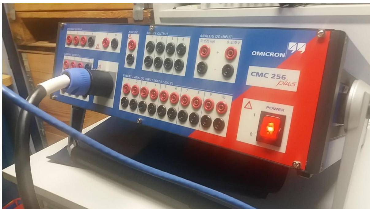
Figura 4.18 – Simulador de sistema elétrico de potência OMICRON CMC 256 Plus utilizado para avaliar o desempenho da metodologia de testes proposta.
