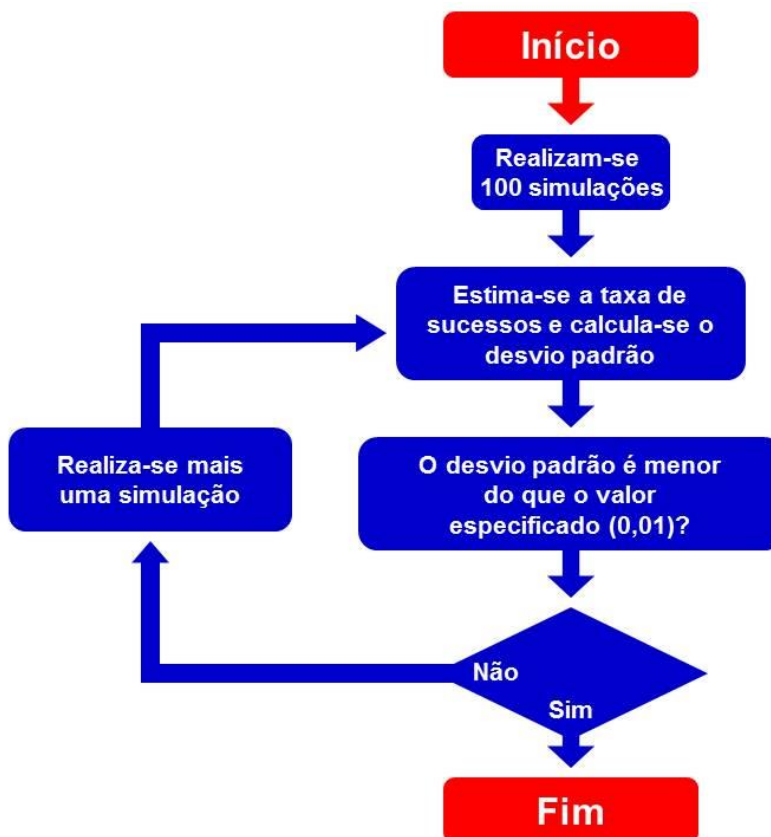
Figura 2.3 – Sequência dos procedimentos adotados para a avaliação da confiabilidade dos ajustes de relés diferenciais proposta em (SOUZA, 2012)
