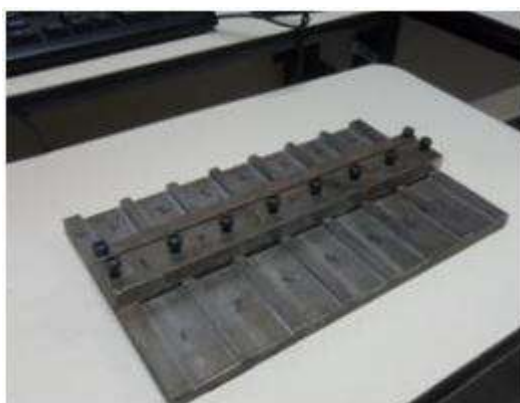
Figura 57 - Gabarito de aço para colagem de juntas coladas
