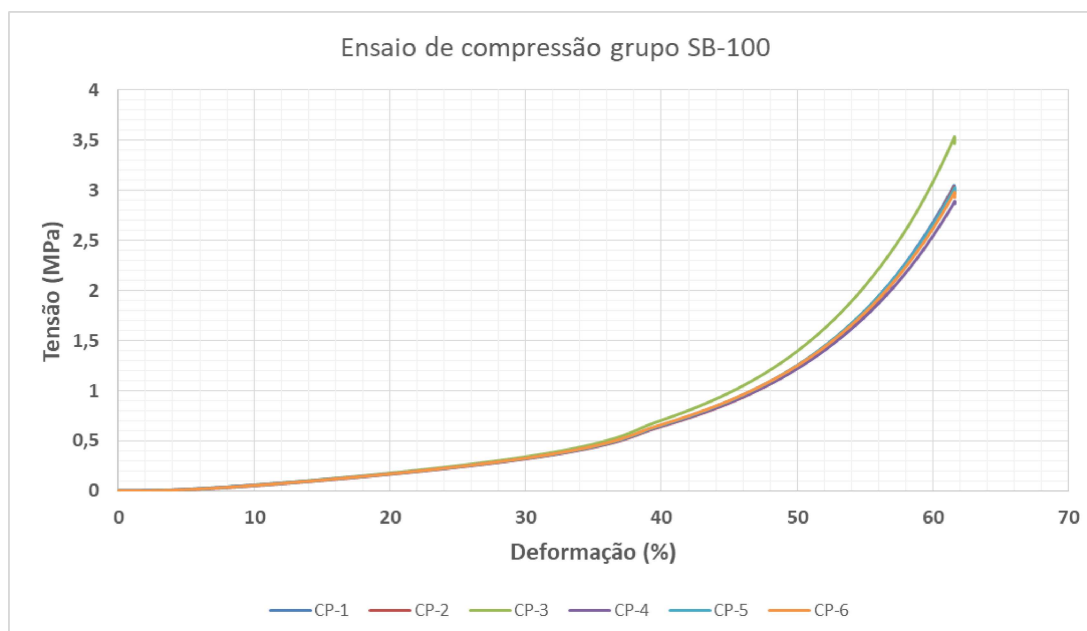
Figura 64 - Curvas dos ensaios de compressão. Grupo SB-100
