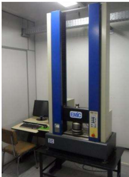
Figura 52 - Máquina de ensaios universais EMIC DL 10000
