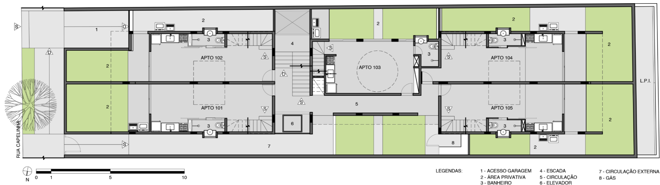
Figura 15 – Planta do pavimento térreo dos Estúdios Capelinha Fonte: Maciel (2009). Produzido pelo autor, 2020.
