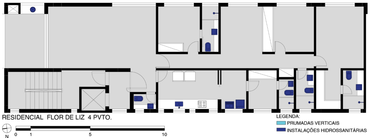
Figura 100 – Prumadas verticais e instalações hidrossanitárias do Residencial Flor de Liz Fonte: Alvarenga e Figueiró (2012). Produzido pelo autor, 2020.
