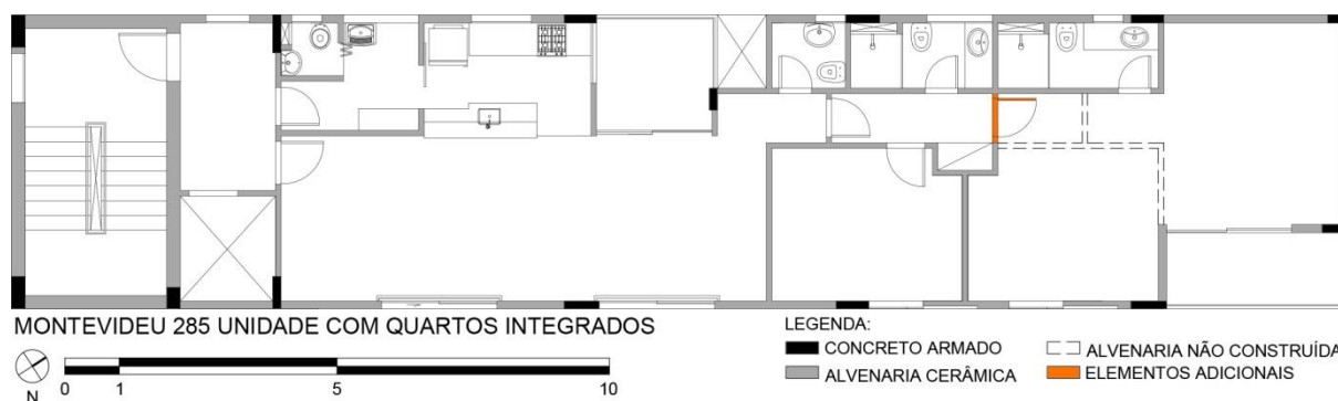
Figura 81 – Quartos integrados em unidade do Montevideo 285, conforme relato do morador Fonte: Teixeira (2008). Produzido pelo autor, 2020.
