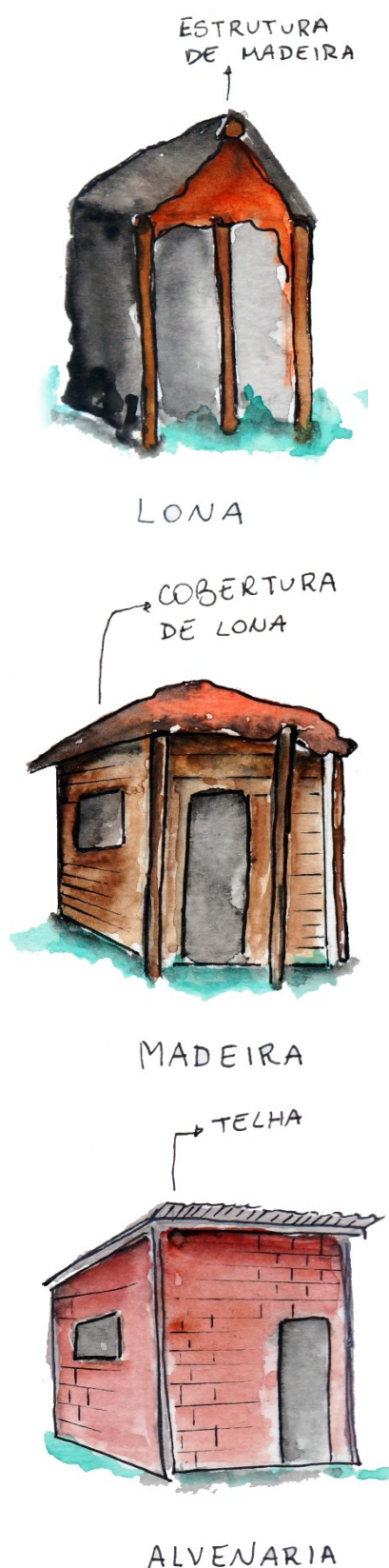
Figura 18 - Diagrama da evolução construtiva
