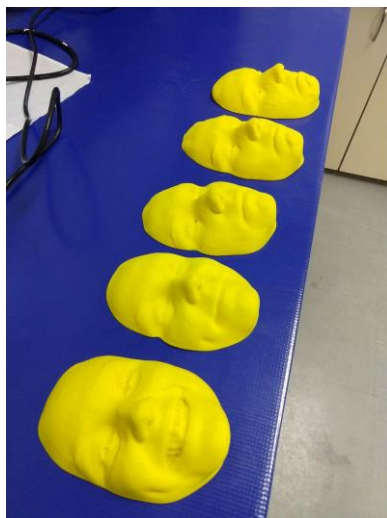
Figura 8 - Faces tridimensionais impressas após o acabamento com as lixas 80 e 220.
