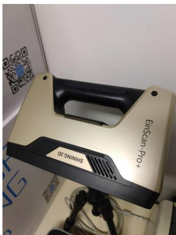
Figura 5 - Aparelho Shining 3D EinScan-Pro+ utilizado para realizar o escaneamento.
