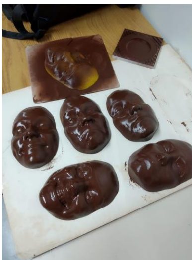
Figura 9 - Faces já com a aplicação do primer e do tingimento na cor marrom
