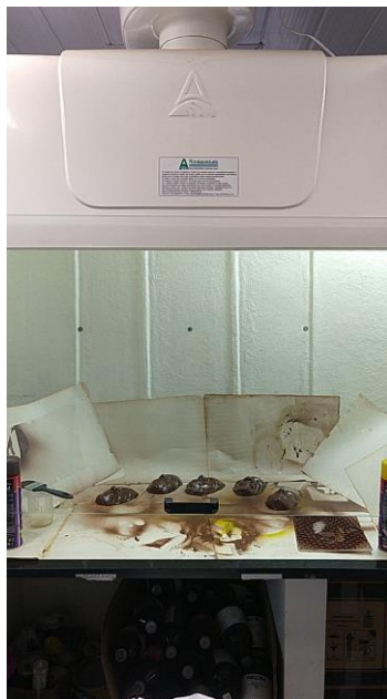
Figura 12 - Estufa a 20 °C preparada para o procedimento de secagem das faces tridimensionais após aplicação do primer e da tinta.
