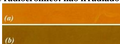
Figura 21 – Filme radiocrômico: não irradiado (a) e irradiado (b).
