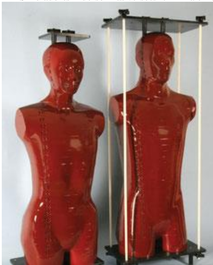
Figura 17 – Simuladores Alderson nas versões feminina e masculina.
