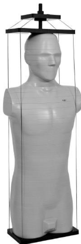
Figura 18 – Simulador antropomórfico Murphy Atom masculino.
