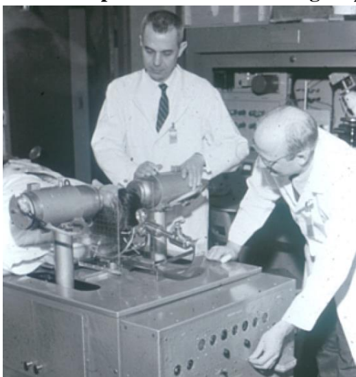
Figura 8 – Primeiro dispositivo clínico de imagem por pósitrons.
