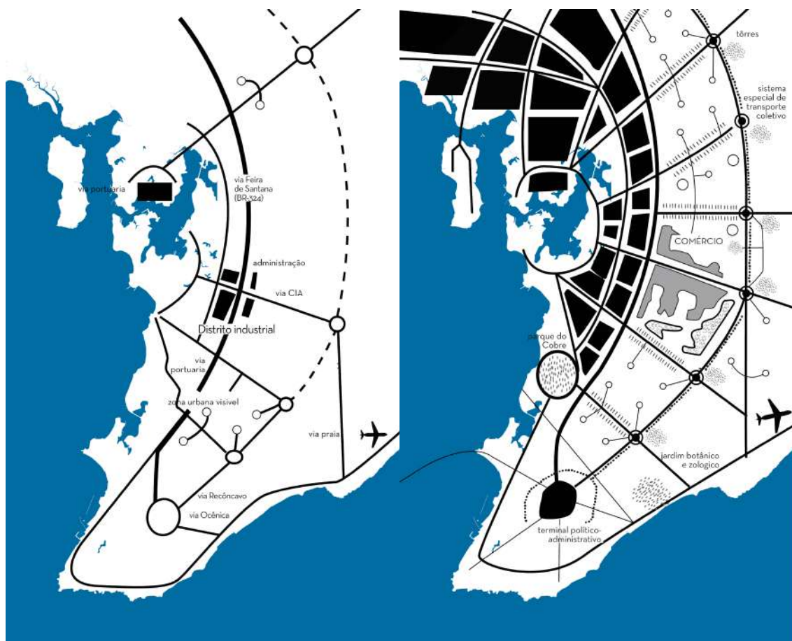
Figura 32 e 33. Plano do CIA: À esquerda, esquema da proposta em sua fase inicial de implantação, onde os blocos em chapados em preto correspondem à ocupação industrial. À direita, temos a segunda fase do CIA, cobrindo uma abrangência territorial e com o novo centro político administrativo consolidado. Fonte: Sampaio (2015). Elaborado pela autora.
