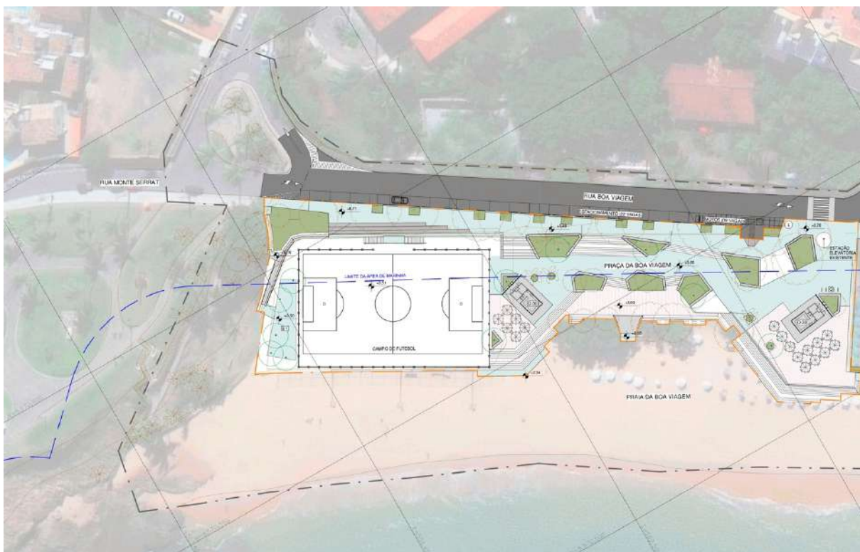
Figura 66. Boa Viagem: projeto impermeabiliza parte da área de praia com piso em concreto poroso pigmentado. Fonte: SALVADOR (2019a).
