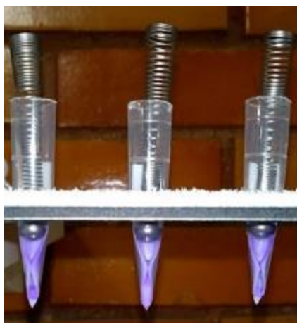
Figura 39. Foto da fase aceptora suportada após a extração do corante violeta genciana.
