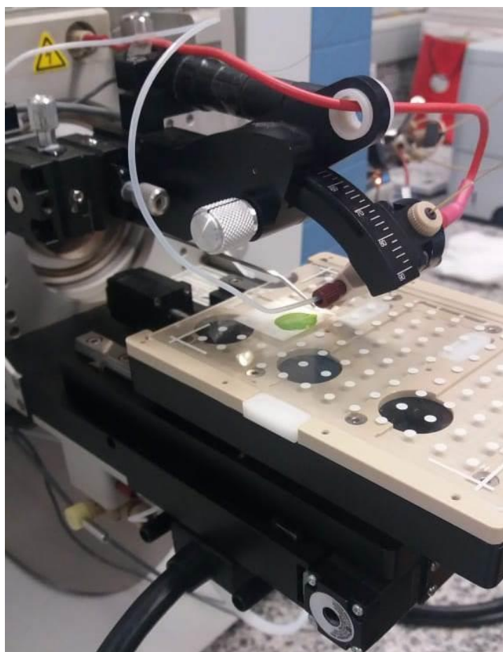
Figura 4.2 - Fonte de ionização DESI (Omni Spray Ion Source 2-D modelo OS-3201 da empresa Prosolia, EUA) utilizada nesse trabalho.
