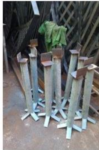
Peças fabricadas para fundação da grade
