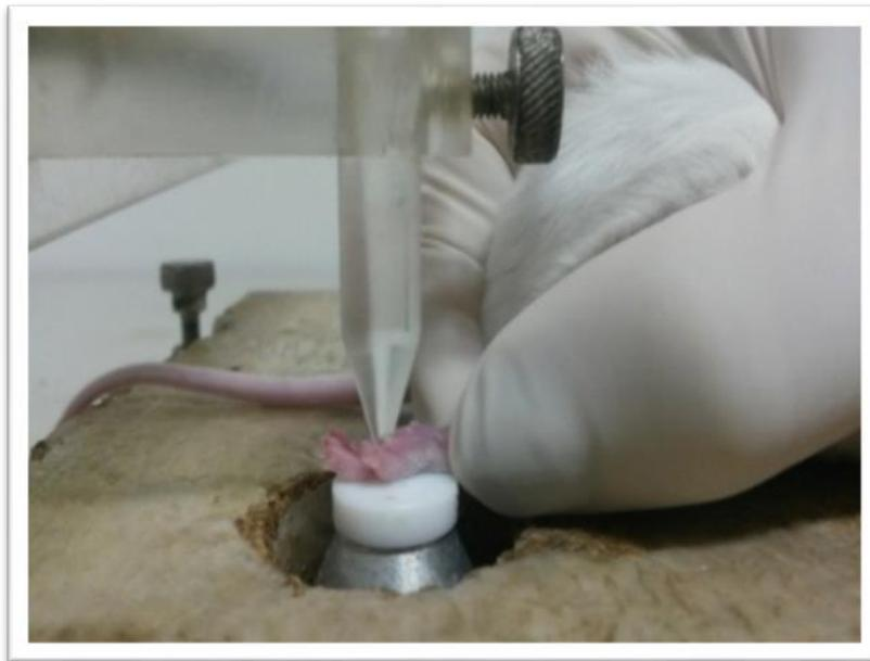
**Figura 1- Teste algesimétrico para mensuração do limiar nociceptivo na pata de camundongos.** Na figura observamos a superfície plantar posterior de camundongo apoiada à superfície cônica do aparelho, que irá exercer uma pressão sob a pata. A intensidade da pressão irá ocasionar o reflexo de retirada da pata do animal, que será então definido como limiar nociceptivo, e este é mensurado em gramas.
