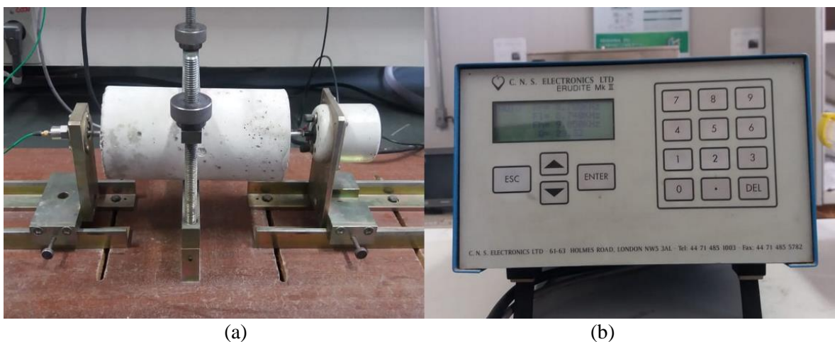
Figura 4.7 - (a) Montagem do ensaio de módulo de elasticidade dinâmico e (b) Equipamento Erudite MKII Ressonante Frequency Test System.
