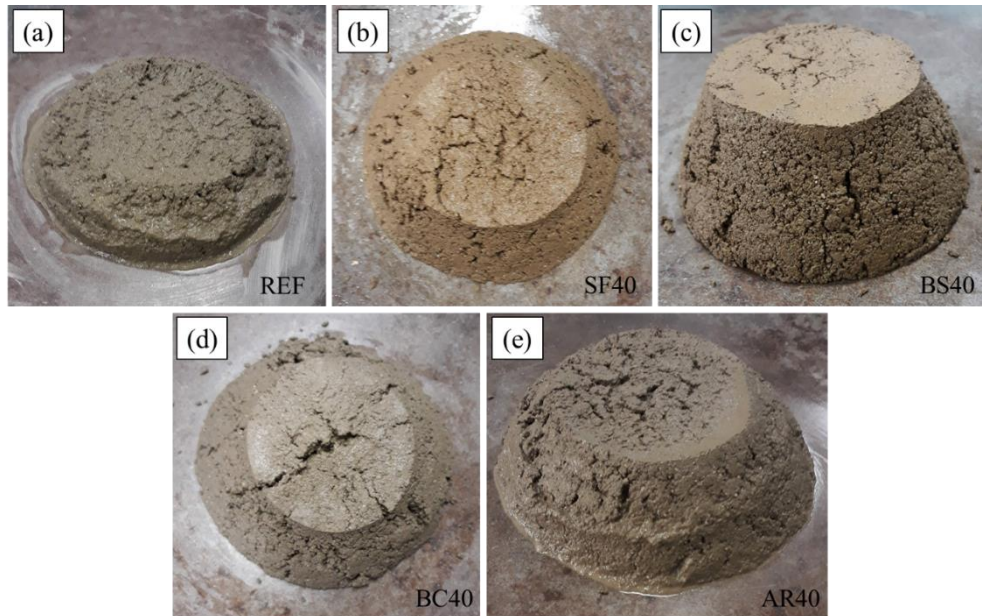
Figura 5.12 - Fotos do espalhamento na Flow Table do microconcreto (a) de referência, (b) SF40, (c) BS40, (d) BC40 e (e) AR40.
