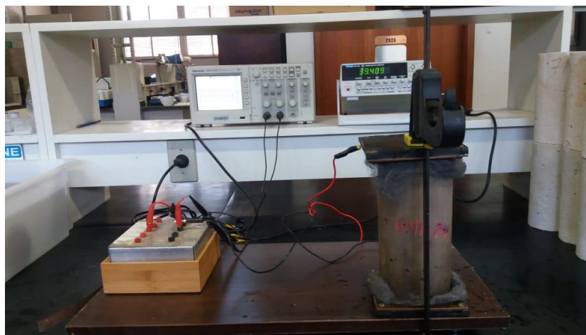
Figura 4.8 - Montagem do sistema para realização do ensaio de resistividade elétrica
