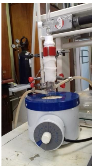
Figura 12 - Sistema da reação de rearranjo de Claisen utilizando manta aquecedora e tudo reacional.
