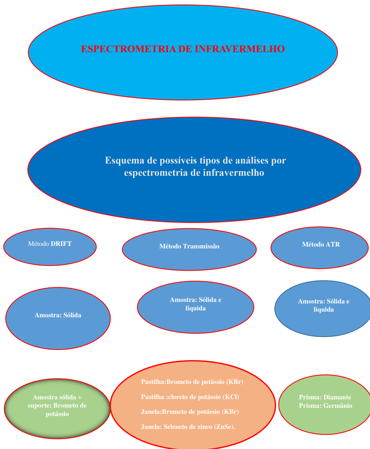
Figura 9: Esquema de possíveis análises no espectrômetro de infravermelho (FTIR).
