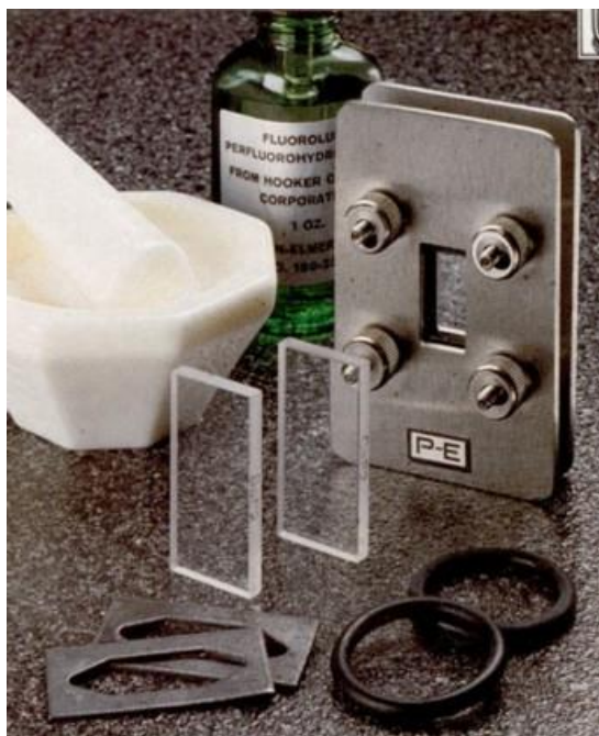
Figura 4: Célula desmontável, com janelas e juntas de vedação. Também vê-se gral de ágata e pistilo.
