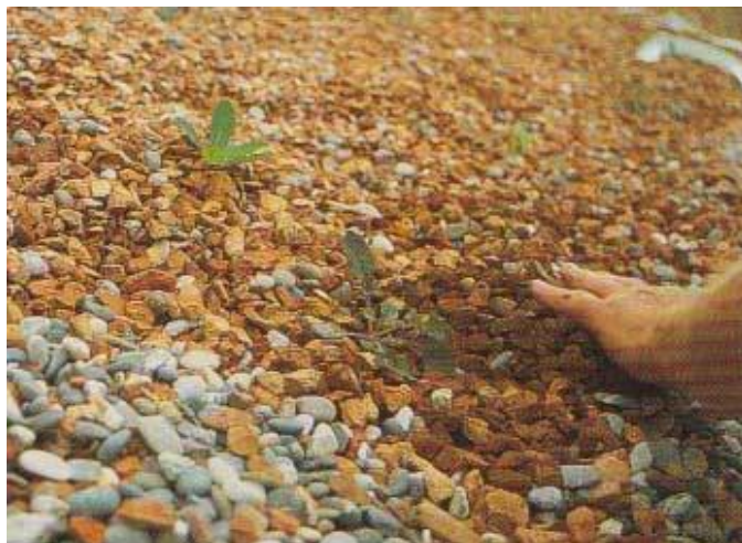
Figura 3.36 - Substrato composto de seixo rolado e fragmentos de tijolo e telha
