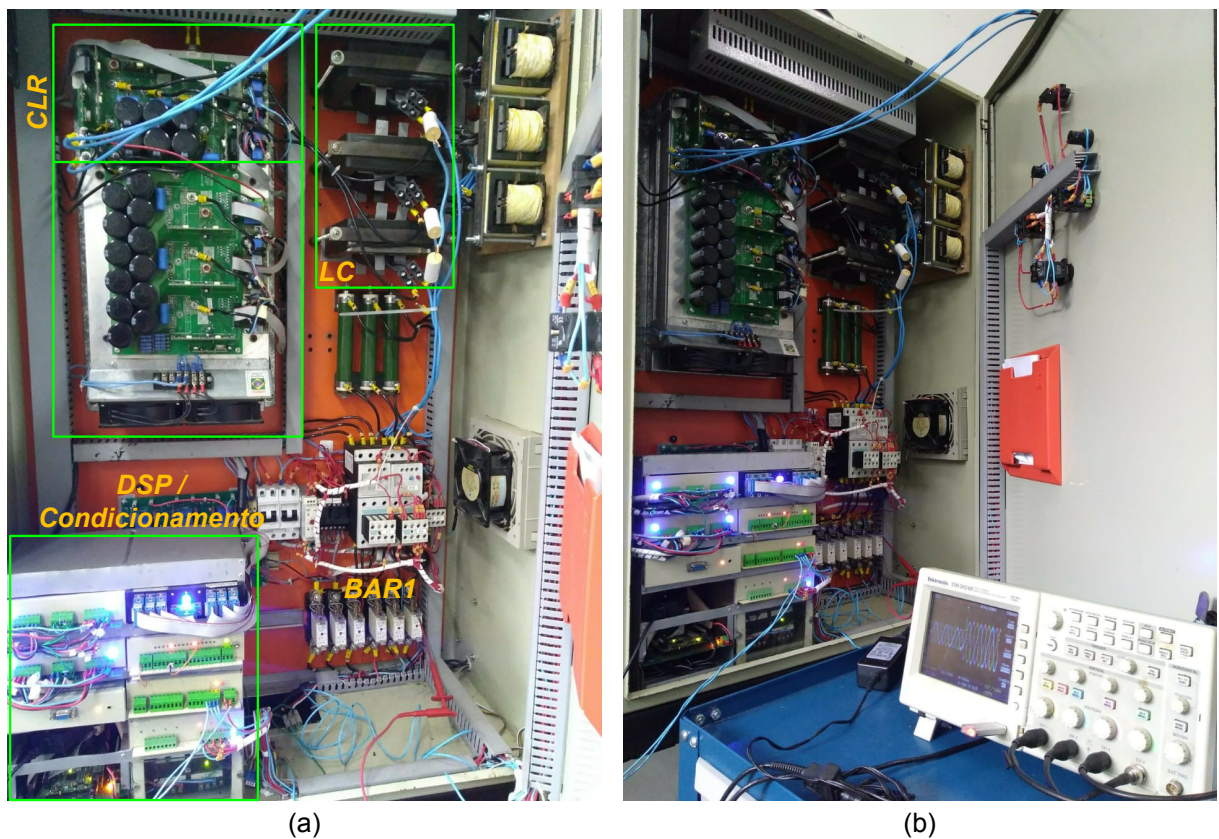
Figura 4.2: Setup Experimental (a) Identificação dos blocos constituintes. (b) Vista externa em operação.
