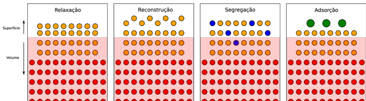
Figura 37 – Os vários fenômenos que ocorrem em uma superfície. Figura retirada da Dissertação de Mestrado de Leonardo Oliveira, “Determinação das Propriedades Eletrônicas e Estruturais Através de Difração de Fotoelétrons (PhD) de Monocamadas de Co Intercaladas na Interface Grafeno/Ni(111)”, UFMG, Belo Horizonte, (2019) [48]
