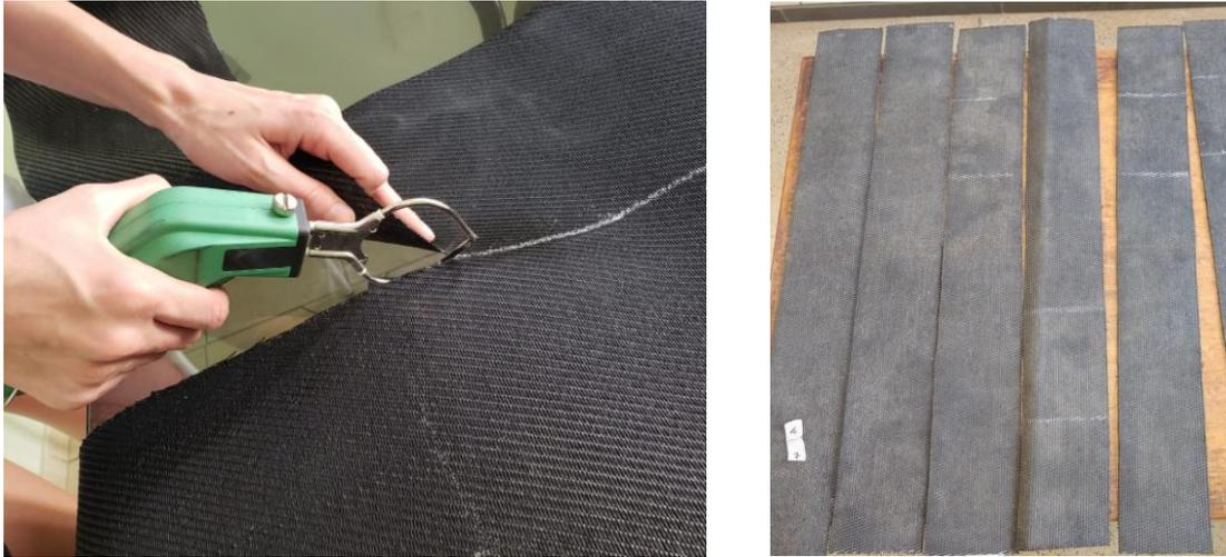
Figura 4-33: (a) Faca elétrica quente utilizada para cortar os espécimes geotêxteis e (b) espécimes cortados.
