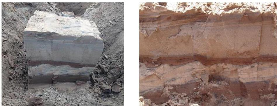
Figura 2-11: Segregação de partículas no interior de um tubo geotêxtil (Freitas Silva, 2017).
