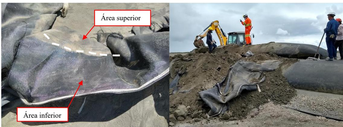
a) variação de impregnação do geotêxtil.
