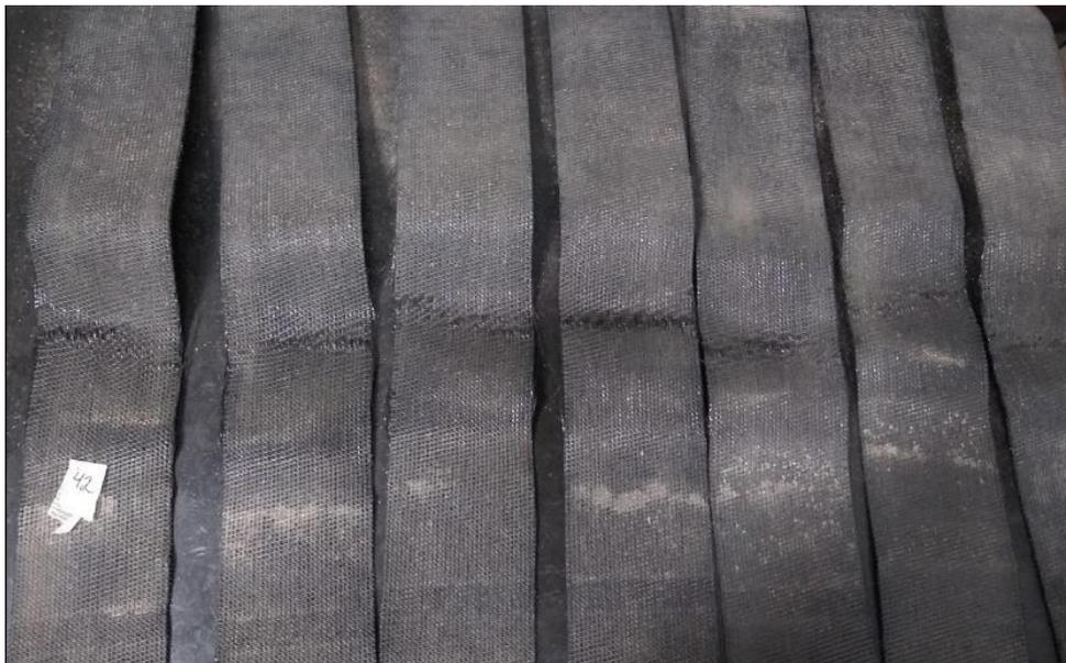
Figura 7-12: Aspectos dos espécimes após a ruptura cortados no sentido MD.
