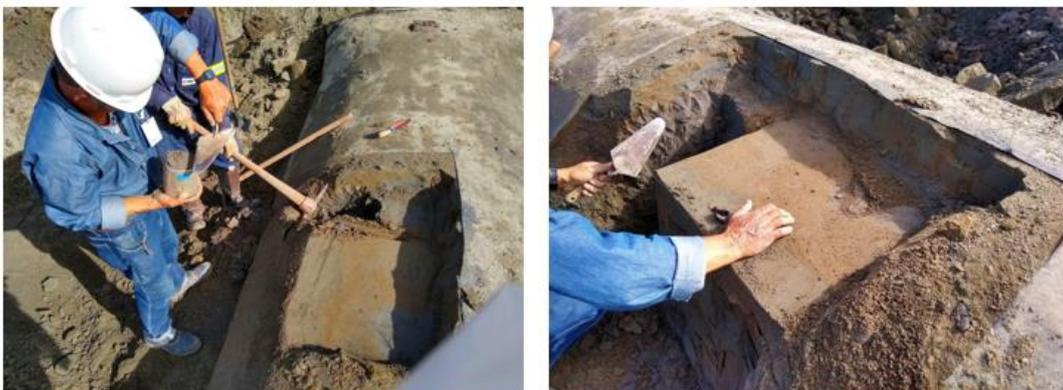
Figura 4-16: Moldagem do bloco indeformado do TG5 – 1º nível do empilhamento.
