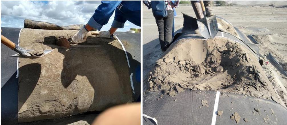
a) Aspecto do rejeito após a abertura do TG. b) Coleta de amostra deformada.
