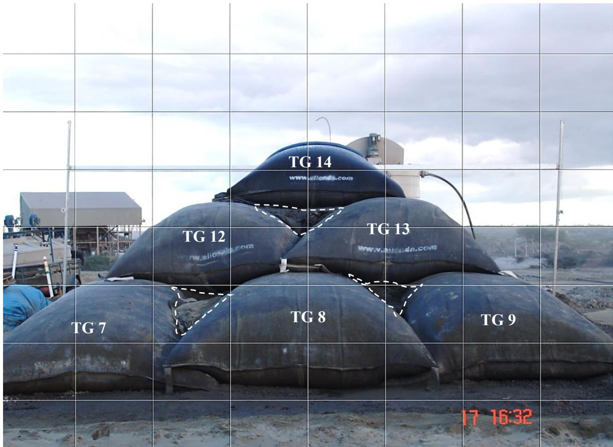
Figura 3-15: Empilhamento de tubos geotêxteis (Freitas Silva, 2017).
