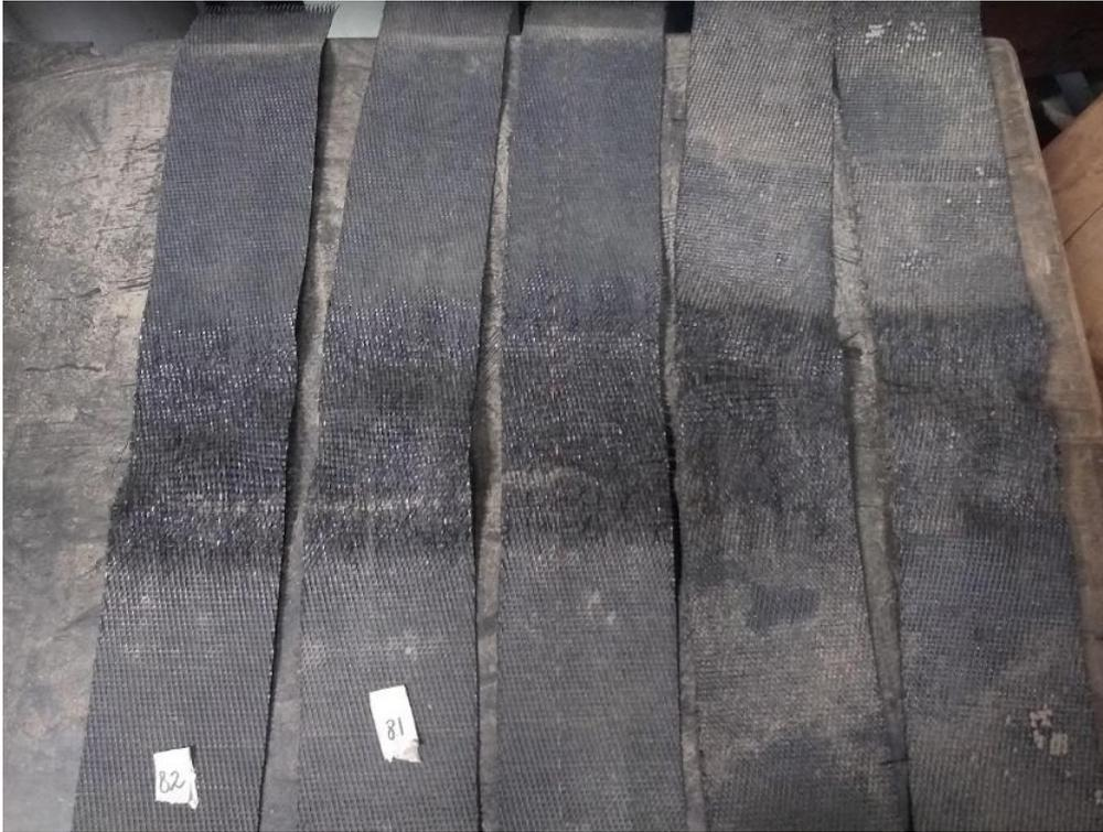
Figura 7-13: Aspectos dos espécimes cortados no sentido CMD após a ruptura.
