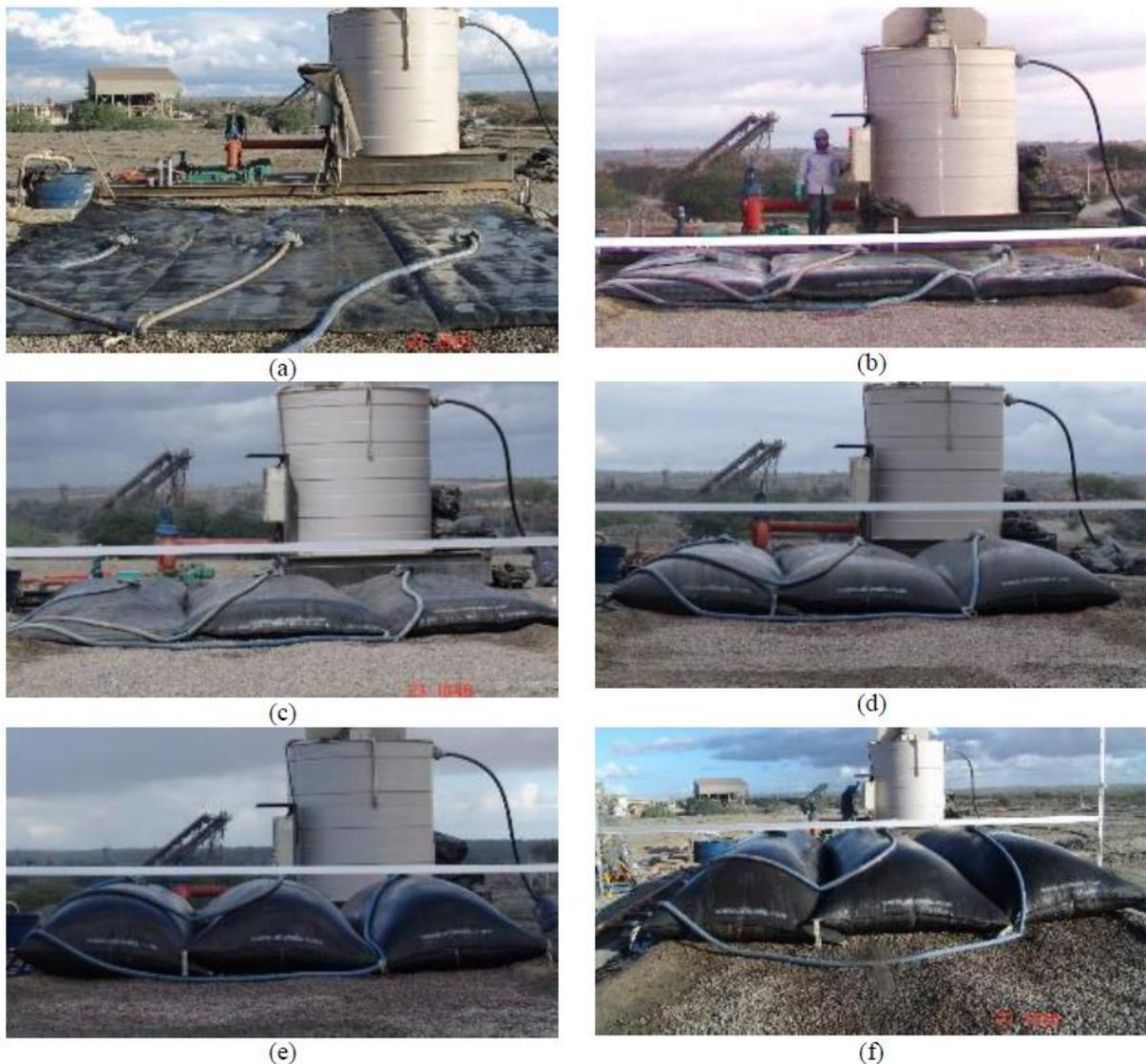
Figura 3-5: Variação da forma em função da altura (H) dos TG: (a) primeira fase de enchimento,  $H \sim 0,15$  m; (b) segunda fase,  $H \sim 0,35$  m; (c) terceira fase,  $H \sim 0,50$  m; (d) quarta fase,  $H \sim 0,75$  m; (e) quinta fase,  $H \sim 0,90$  m; (f) sexta fase,  $H \sim 1,00$  m (Freitas Silva, 2017).
