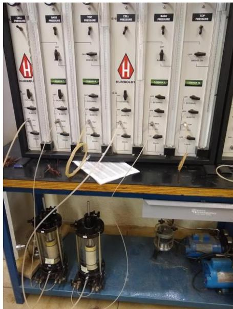
Figura 4-29: Montagem do ensaio de permeabilidade a carga variável.
