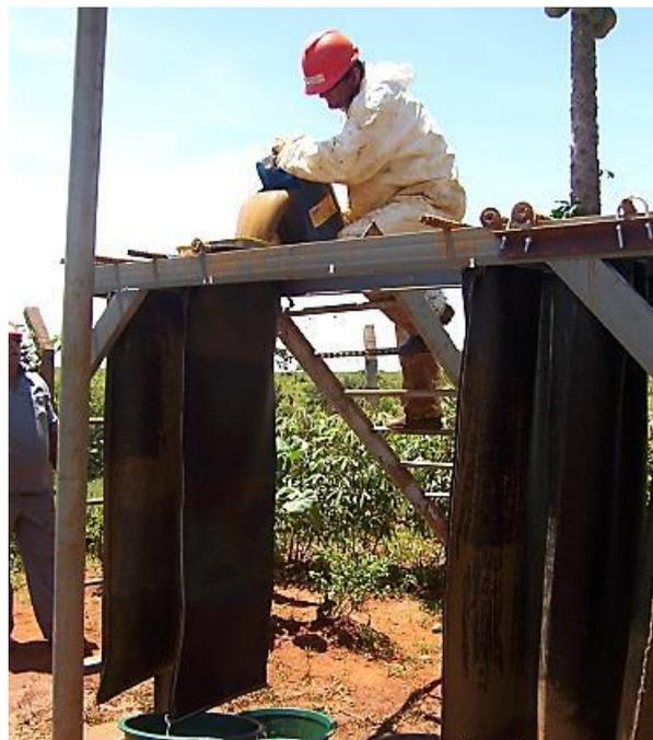
Figura 2-15: Montagem e execução do ensaio de bolsa suspensa de geotêxtil (HBT) (Martins, 2006).
