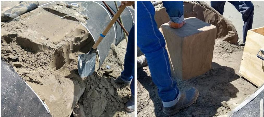
a) Início do processo de moldagem do bloco indeformado. b) Finalização da moldagem.
