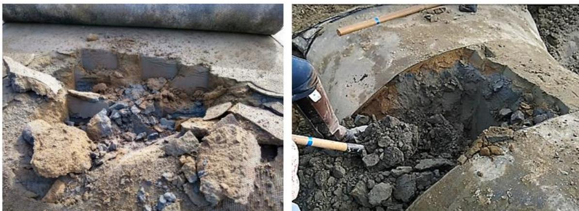
Figura 4-14: Coleta de amostras deformadas do TG5 – 1º nível do empilhamento.
