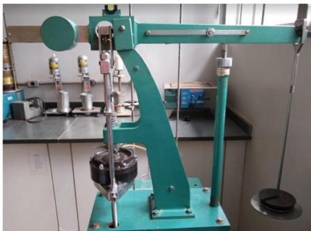
Figura 4-27: Prensa de adensamento tipo Bishop do LabGeo da UFMG.
