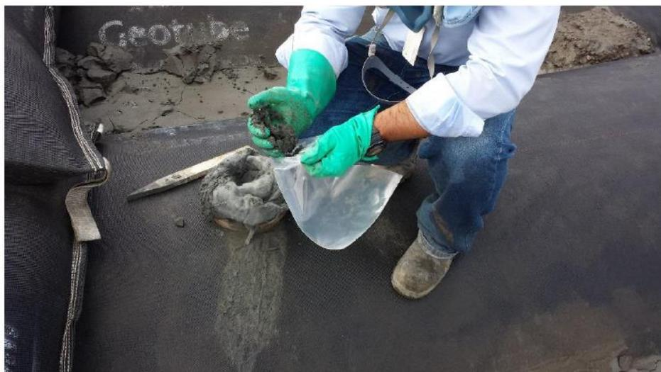
Figura 3-16: Coleta de amostra de rejeito no interior do tubo geotêxtil (Freitas Silva, 2017).
