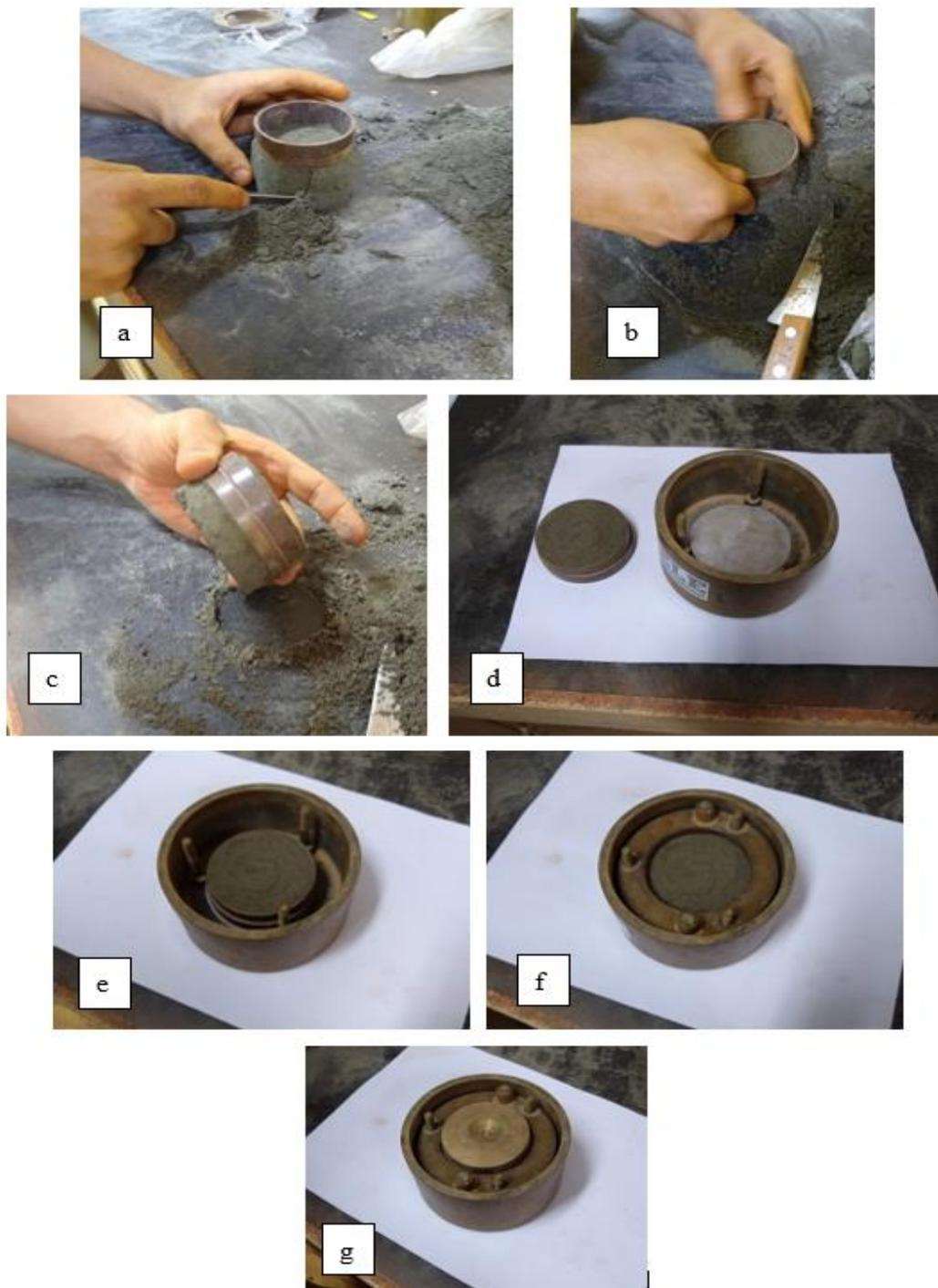
Figura 4-25: Preparação do ensaio edométrico: (a), (b) e (c) mostram a sequência de moldagem e inserção do corpo de prova no anel metálico; (d), (e), (f) e (g) mostram a inserção do corpo de prova na bacia de adensamento.
