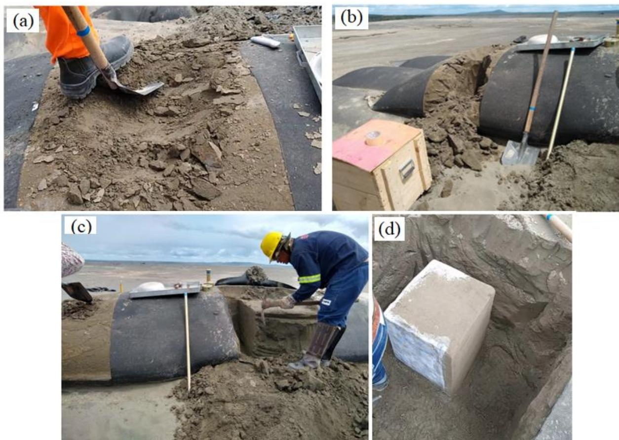
Figura 4-10: Sequência de exumação do tubo geotêxtil G10: (a) Início de coleta de amostra deformada na extremidade esquerda do tubo; (b) ao final da coleta de amostra deformada; (c) início da moldagem do bloco indeformado; (d) bloco indeformado sendo parafinado geotêxtil.
