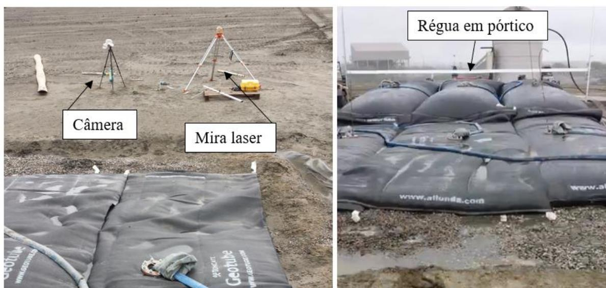
Figura 3-4: Alguns instrumentos utilizados por Freitas Silva (2017) para monitorar a geometria do empilhamento antes e após o enchimento dos tubos geotêxteis: (a) câmera e mira-laser instalados de frente para a régua em pórtico; (b) localização da régua.
