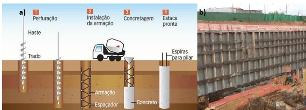
Figura 2.2 - a) Construção das estacas escavadas; b) Obra estudada neste trabalho (NAKAMURA, 2013).
