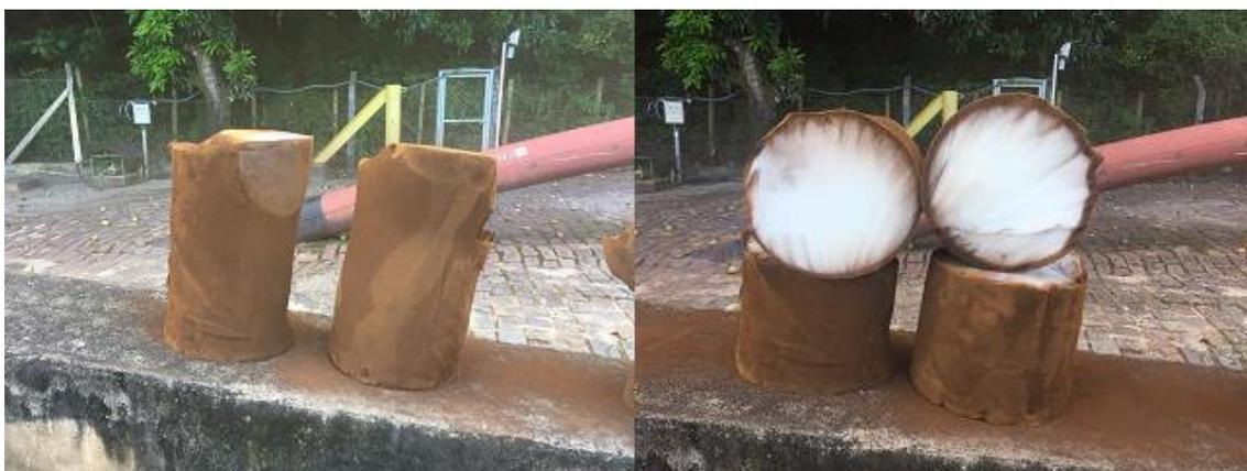
**Figura 18: Pigs de espuma lançados para a secagem do duto durante a recarga do nitrogênio.**
