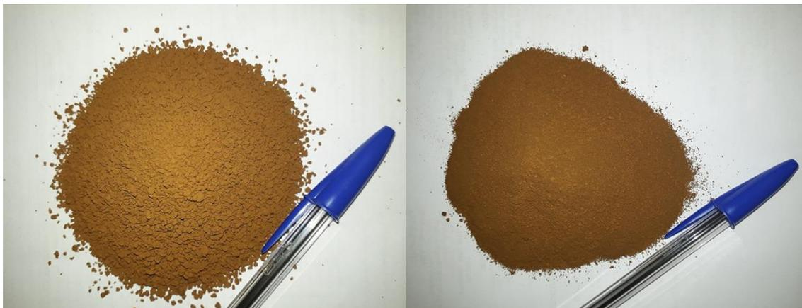
**Figura 19: Material coletado durante a passagem dos pigs de espuma durante recarga do nitrogênio.**
