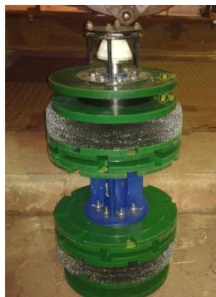
**Figura 13: PIG usado para remoção de material sedimentado.**
