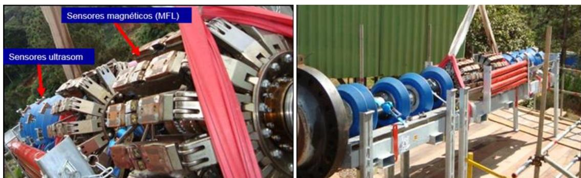
**Figura 10: Pig instrumentado com ferramentas de ultrassom e MFL.**
