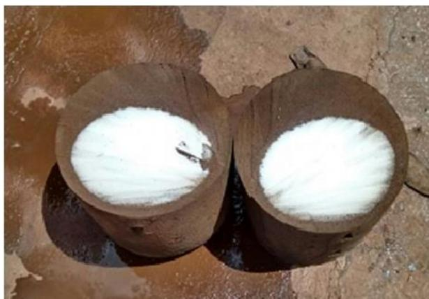
**Figura 14:PIG de espuma com nível de impregnação inadequado.**
