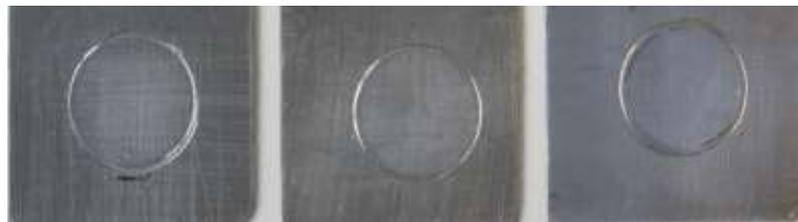
**Tabela 6** - Espessura e aderência do revestimento de PET-PC e tinta em pó base poliéster.
