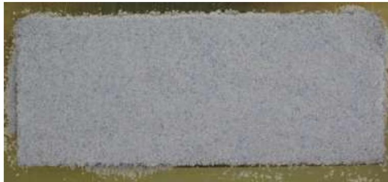
Após 7 minutos, a prensa foi desligada e resfriada com água corrente por 3 minutos, a chapa recoberta foi retirada e exposta à temperatura ambiente por 24 horas, para finalização do processo de resfriamento. A Figura 16 apresenta o aspecto da chapa de aço carbono revestida com o revestimento de PET-PC.
