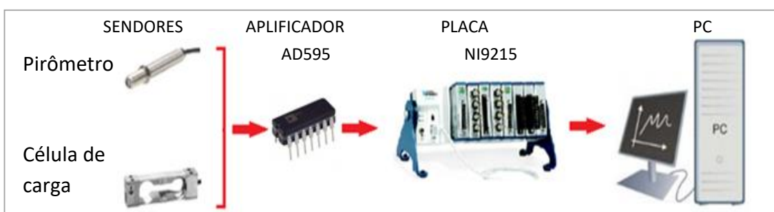
Figura 3.5 - Diagrama do sistema de aquisição de dados.
