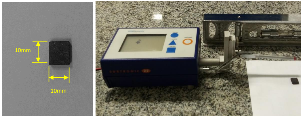
Figura 3.8: exemplo de amostra retirada de uma pastilha de freio e rugosímetro Taylor Hobson Precision, modelo Surtronic 25.
