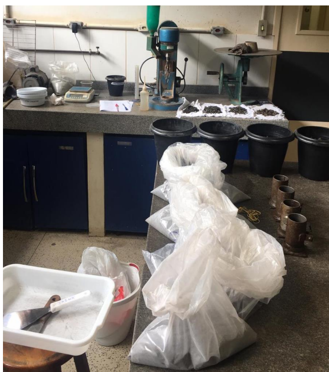
Figura 19. Materiais beneficiados separados nas frações do traço em recipientes independentes
