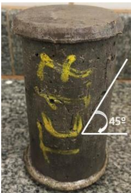
Figura 28. Corpo de prova com agregados convencionais após rompimento a compressão simples aos 28 dias de idade
