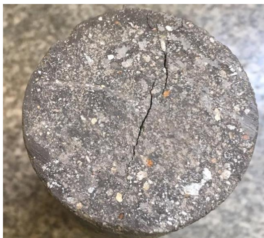
Figura 30. Base de um corpo de prova com agregados convencionais rompido à tração por compressão diametral aos 28 dias de idade
