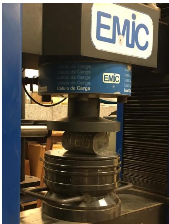
Figura 12. Corpo de prova submetido à tração por compressão diametral
