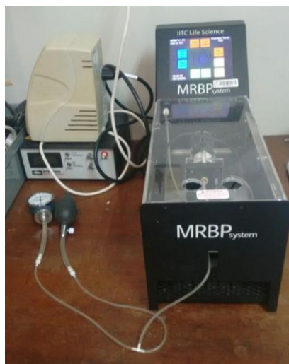
Figura 7 - Pletismógrafo para medida da PAS em camundongos não anestesiados.
