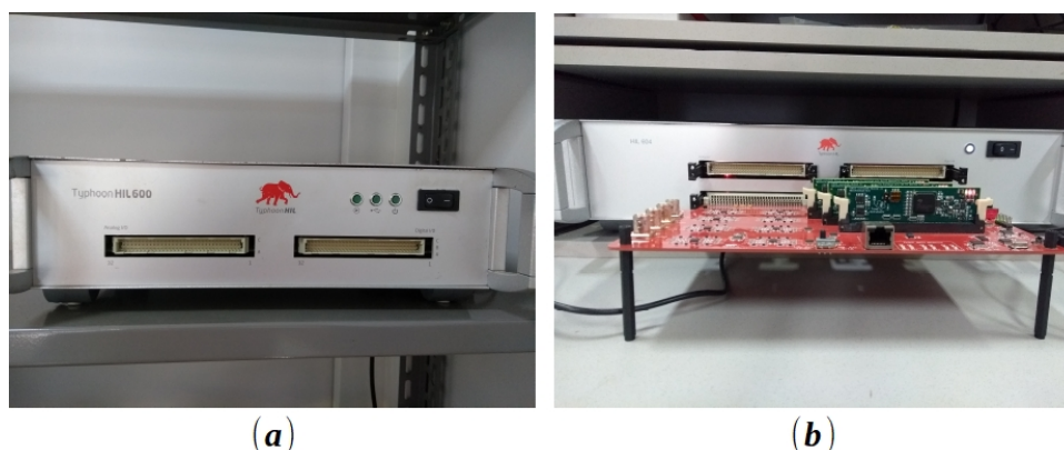
Figura 5.4 – Hardware de simulação em tempo real. (a) HIL 600. (b) HIL 604.
