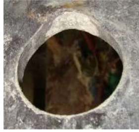
Figura 2.10: Escoamento da chapa na região que entrou em contato com a barra passante (Xiao et al. , 2016).
