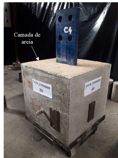
(d) Detalhe do protótipo com camada de areia no topo do bloco
