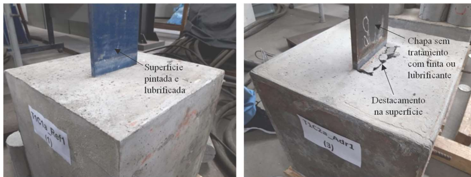
(c) Destacamento no topo do bloco dos protótipos sem tratamento para remoção da aderência entre a chapa e o concreto (Adr1).
