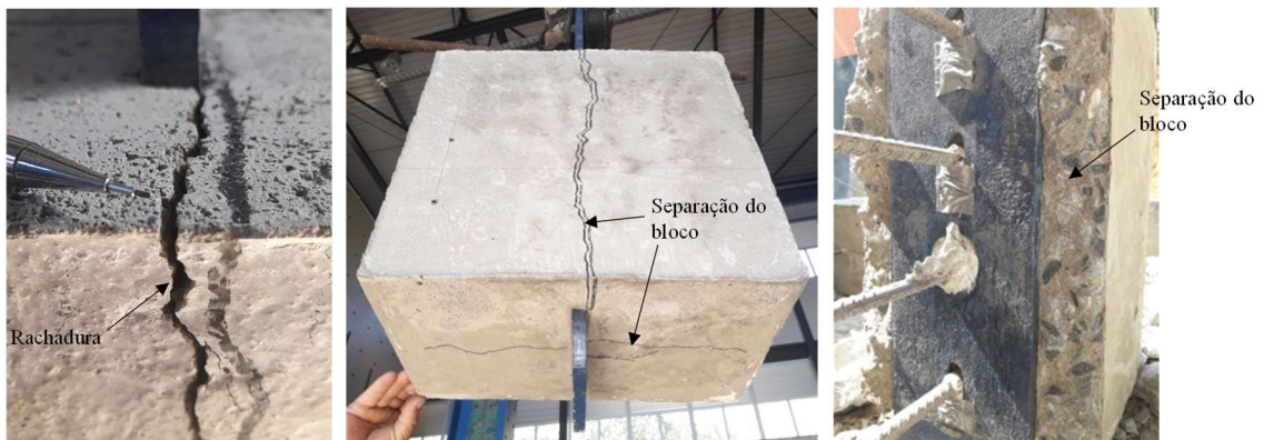
(b) Separação do bloco dos protótipos da tipologia T2
