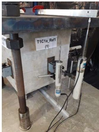
(b) Transdutores para medição do deslizamento entre chapa e concreto
