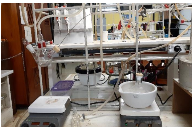
Figura 16: Canulagem do Reagente de Grignard.
