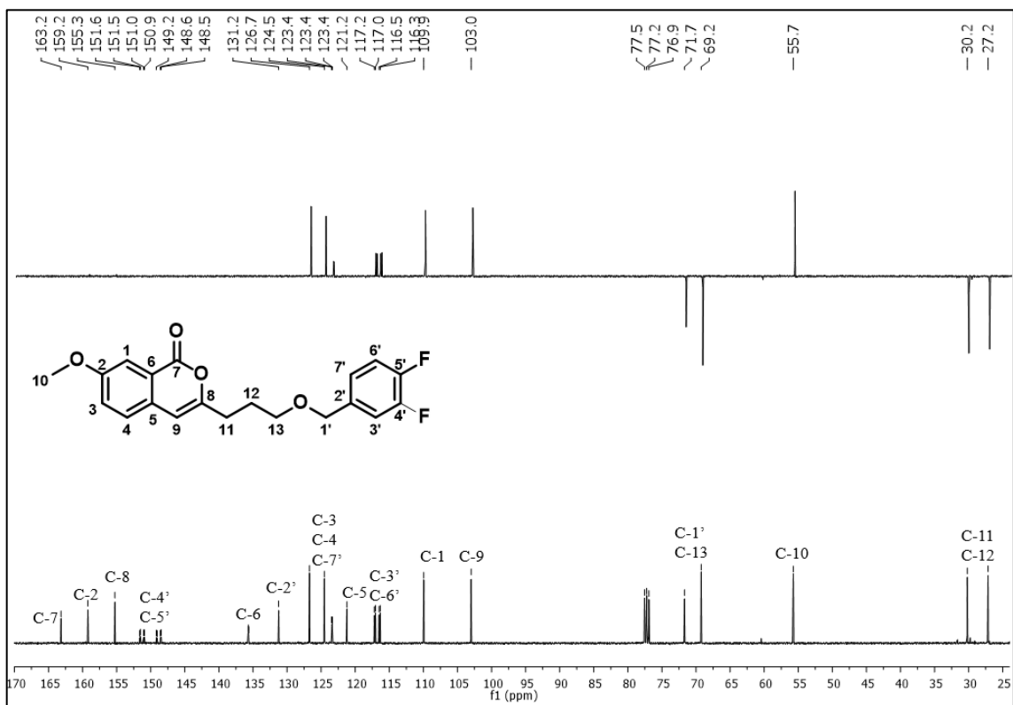
Figura 128. Espectro de RMN de ^{13}\text{C} (a) e subspectro DEPT 135 (b) de 80i (100 MHz, \text{CDCl}_3 ).
